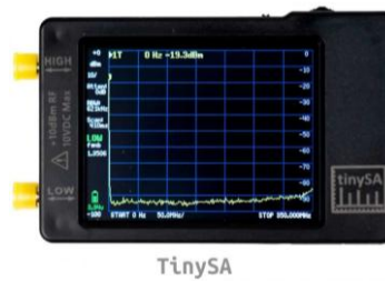
Figura 3-3 TinySA es un analizador de espectro portátil de código abierto.
