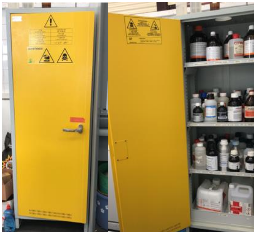
Figura 3-9 Armario de seguridad de reactivos líquidos
