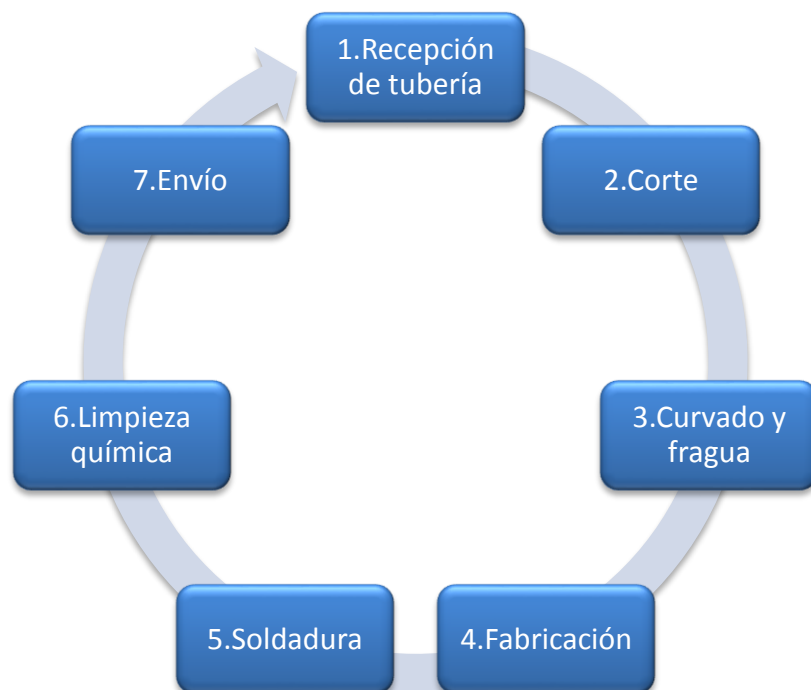
Figura 3-13 Descomposición funcional del taller de tubos
