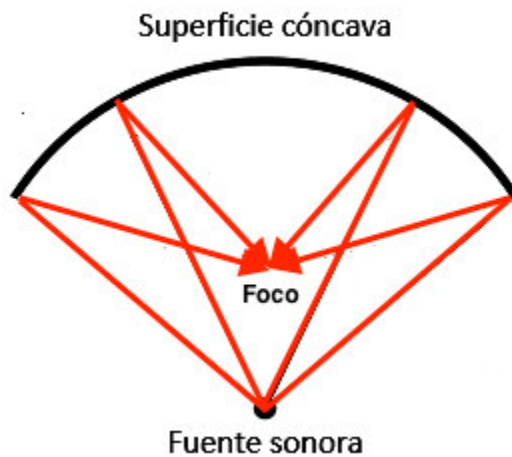
Figura 2-9 Focalización sonora debida a superficie cóncava
