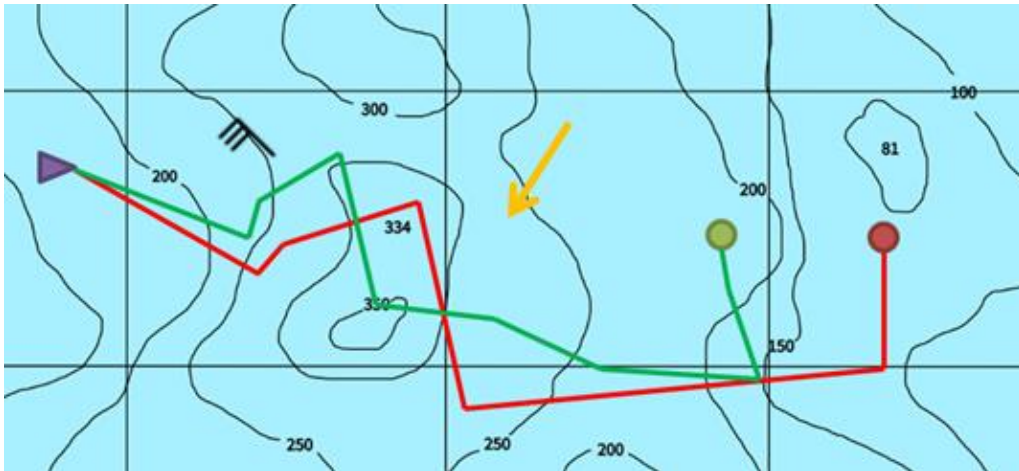
Figura 1-1 Ilustración gráfica de la diferencia entre la estimación de la derrota sin tener en cuenta los efectos del viento y la corriente (rojo), con respecto a la real (verde) [Autoría Propia].
