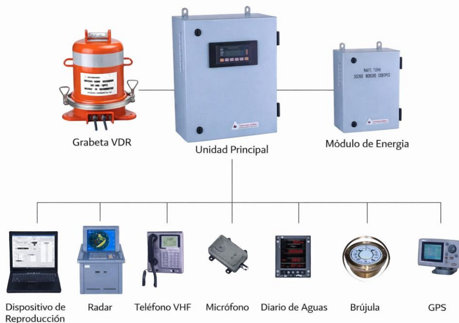
Figura 2-5 Arquitectura VDR y equipos asociados [27]
