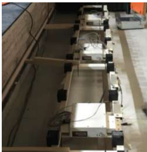
Figura 2-13 Instalación de barrera de ultrasonidos. (Elaboración propia)
