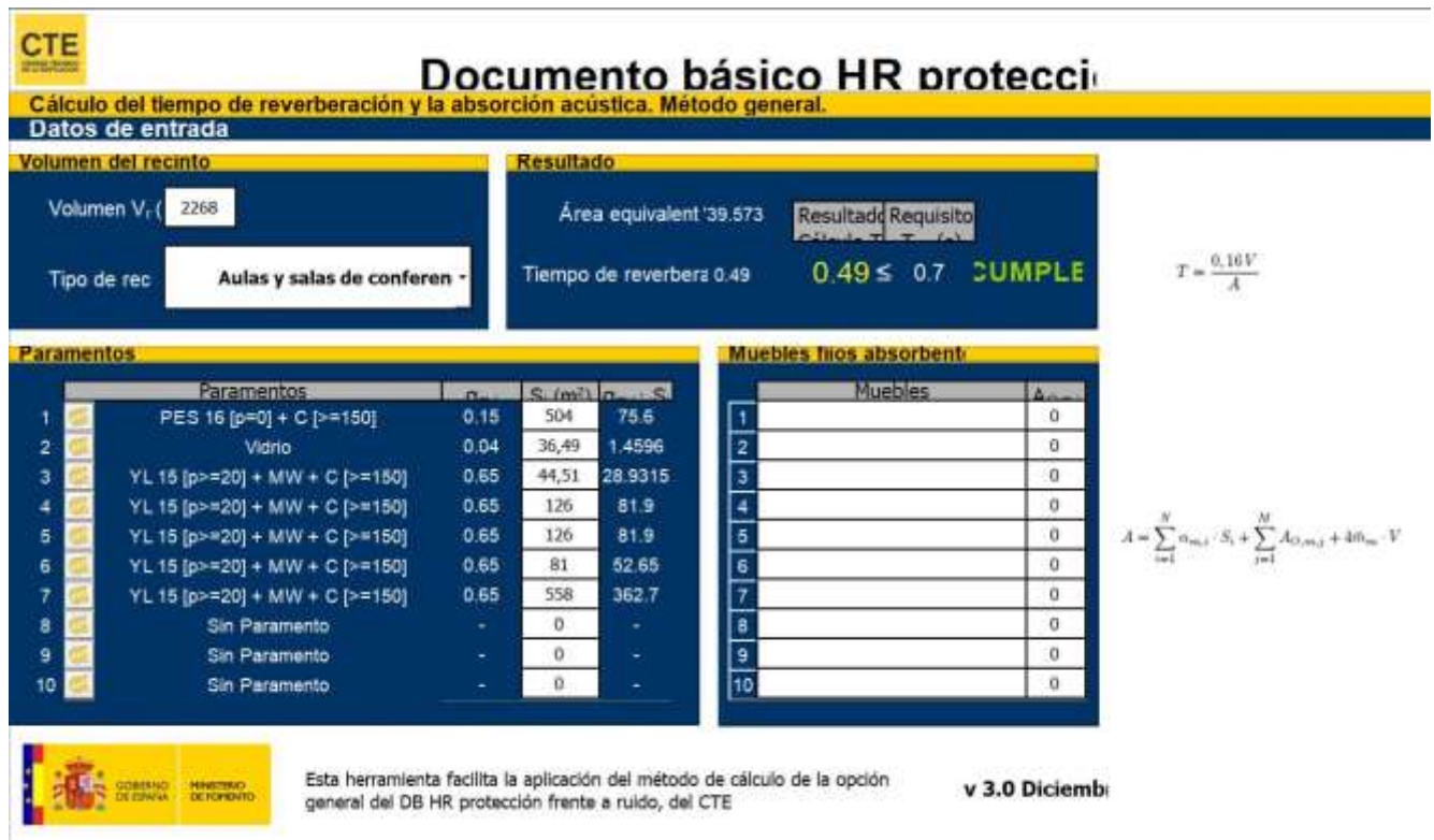
Figura 5-17 Cálculo del tiempo de reverberación con aplicación del DB HR. [6]
