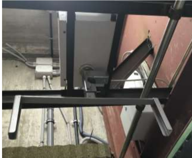
Figura 2-12 Mecanismo de accionamiento del blanco. (Elaboración propia)
