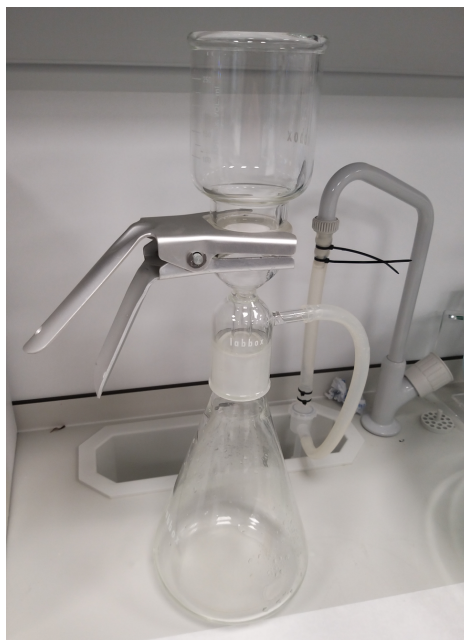
Figura 3-10 Montaje de filtración al vacío
