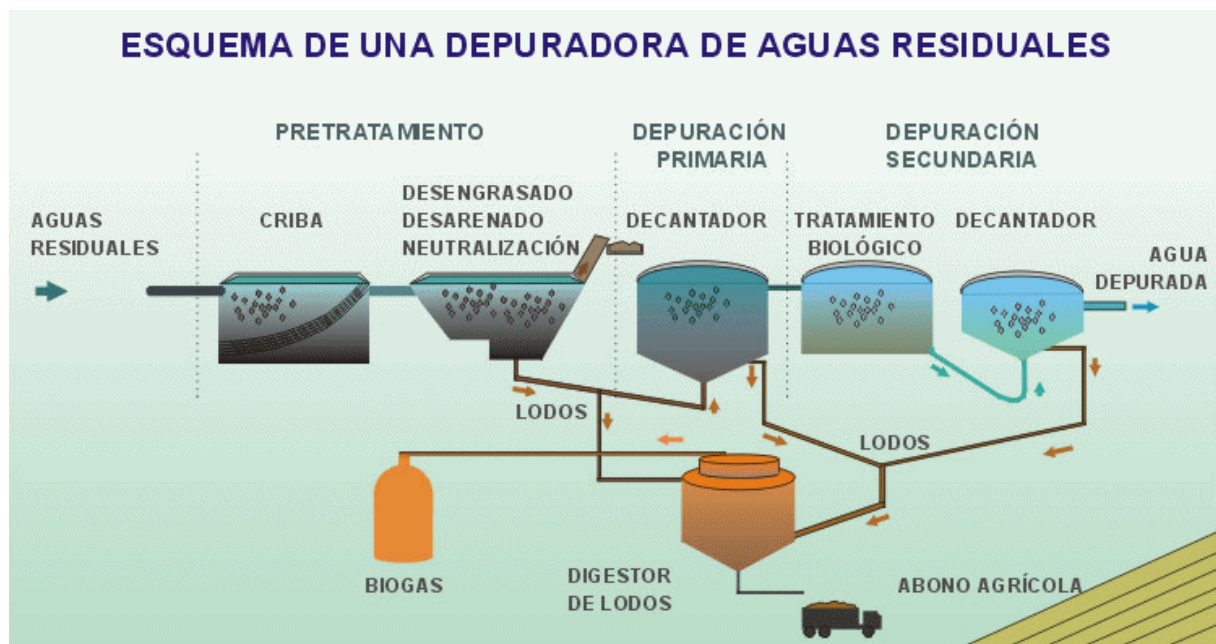
Figura 2-4 Esquema depuradora convencional aguas residuales [25]
