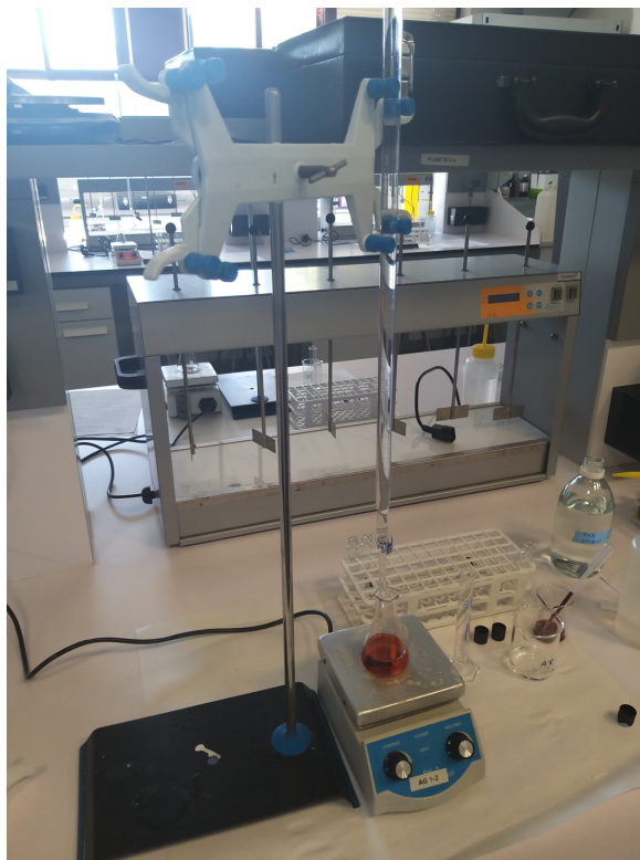
Figura 3-27 Montaje para la medición de la DQO
