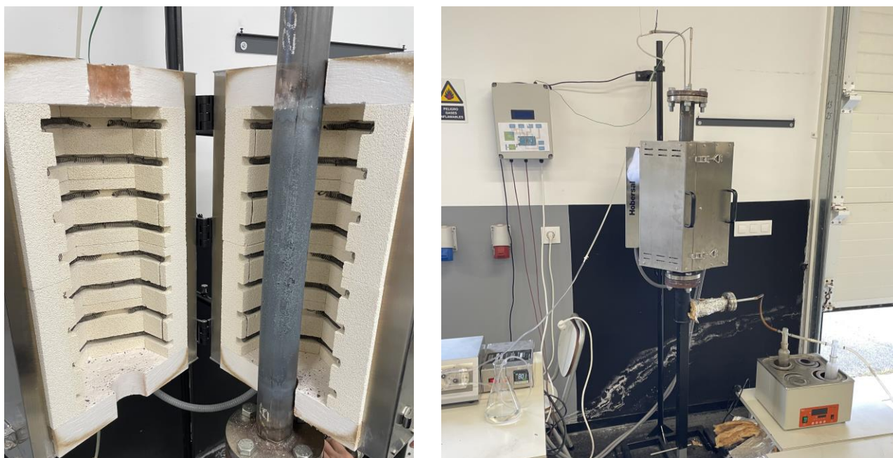
Figura 3-14. (izquierda) Imagen del interior del horno refractario que envuelve el cilindro en cuyo interior se encuentran la alúmina y se reforma la mezcla de glicerina. (derecha) Imagen del equipo completo del reformado: mezcla de glicerina bombeada por bomba peristáltica (esquina inferior izquierda), reformador (centro), baño termostático y salida del gas (esquina inferior derecha).
