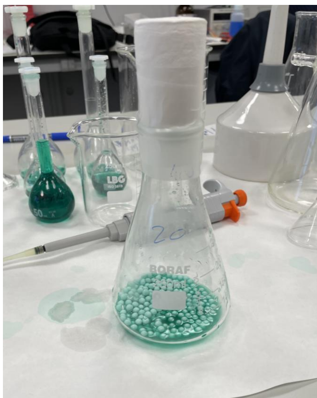
Figura 3-5. Imagen de alúmina impregnada por el método húmedo.
