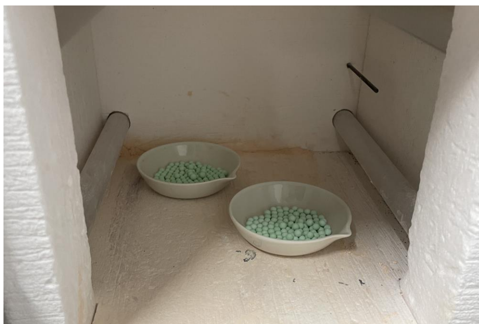
Figura 3-12. Imagen de dos muestras de alúmina impregnadas, previamente a ser calcinadas en la mufla.
