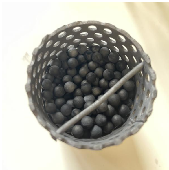
Figura 3-17. Imagen del cestillo con alúmina una vez acabado el reformado, donde se aprecia su color negro debido al coque formado.
