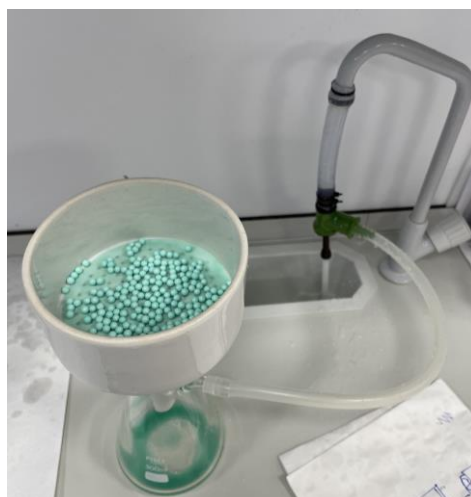
Figura 3-8. Imagen de una muestra de alúmina siendo colada para separar la alúmina de la disolución restante.
