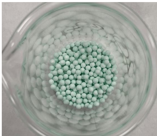
Figura 3-4. Imagen de alúmina impregnada con disolución de Ni.
