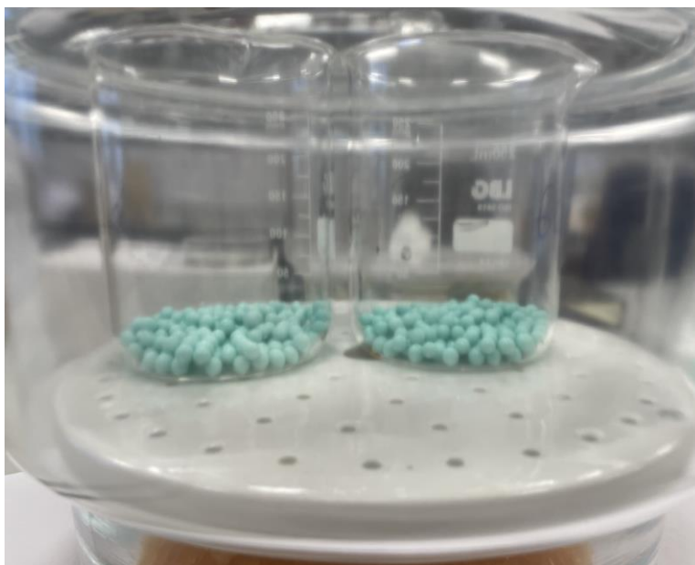
Figura 3-10. Imagen de dos muestras de alúmina, recién impregnadas con disolución 400 (izquierda) y 600 (derecha), en el desecador.
