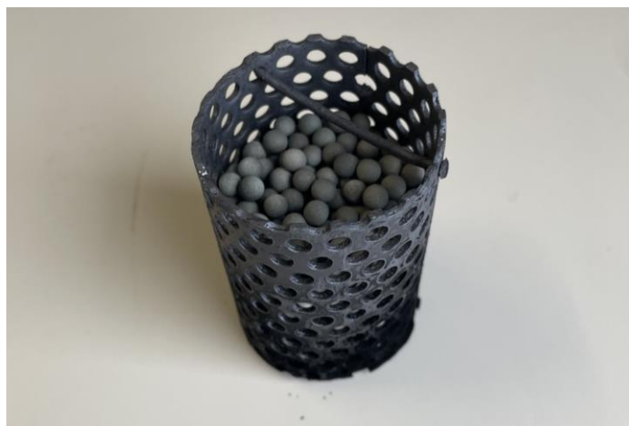
Figura 3-16. Imagen del cestillo lleno de alúmina impregnada.
