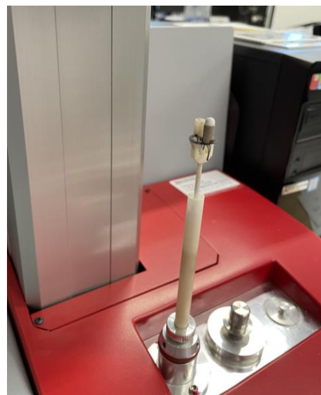
Figura 3-18. (izquierda) Imagen del analizador de temperatura, usado para el análisis termogravimétrico, en funcionamiento. (derecha) Imagen del pocillo con una esfera de alúmina previamente a realizarse un análisis termogravimétrico.
