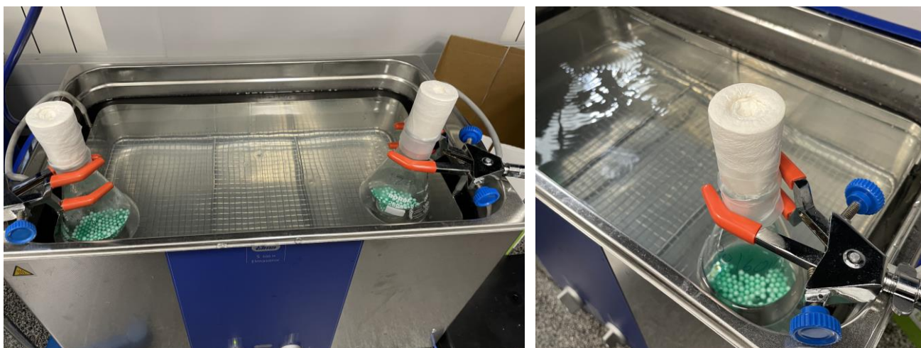
Figura 3-7. (izquierda) Imagen del baño de ultrasonidos sin estar en funcionamiento y con dos muestras de alúmina en su interior impregnándose. (derecha) Imagen del baño ultrasonidos (en funcionamiento) en la que se aprecia el efecto de los ultrasonidos sobre el agua.
