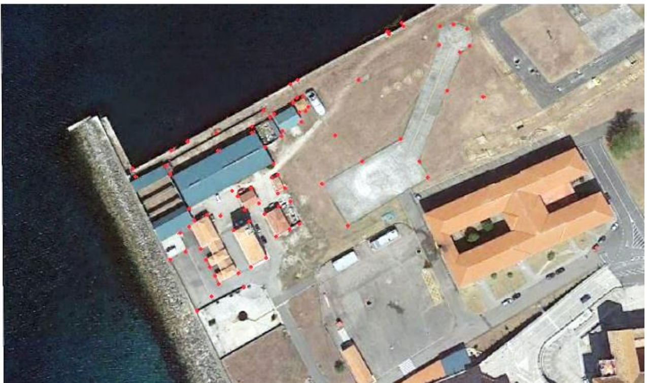
Figura 4-1 Nube de puntos sobre ortofotografía
