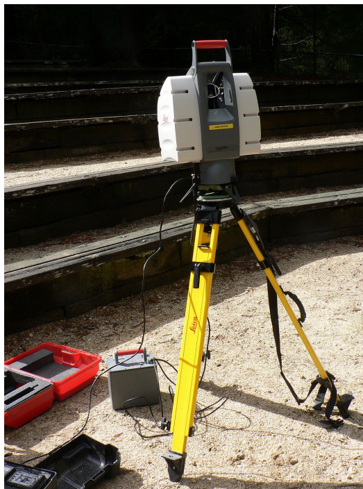
Figura 2-5 Estación laser 3D Leica [8]
