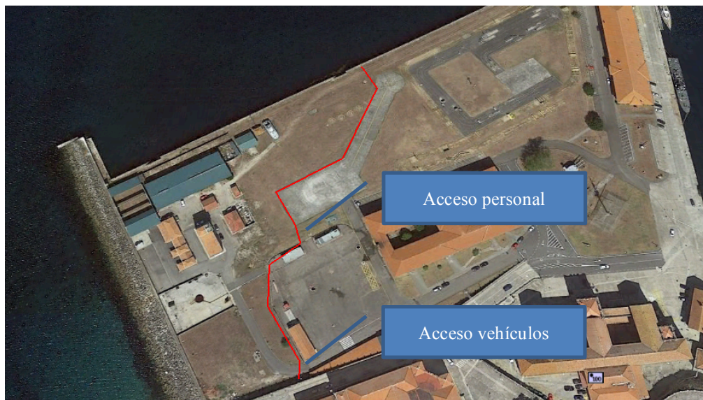
Figura AIII-1 Esquema del trazado del vallado alrededor de la obra
