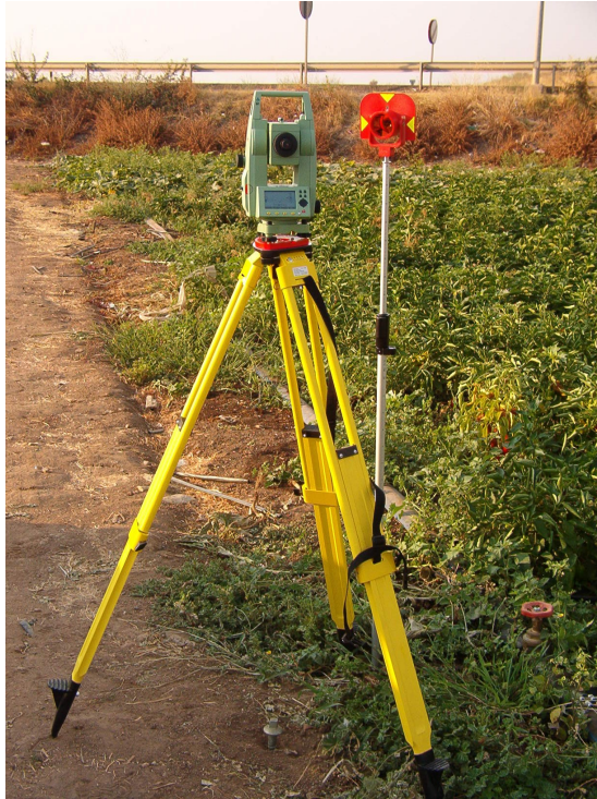
Figura 2-4 Estación total Leica [7]
