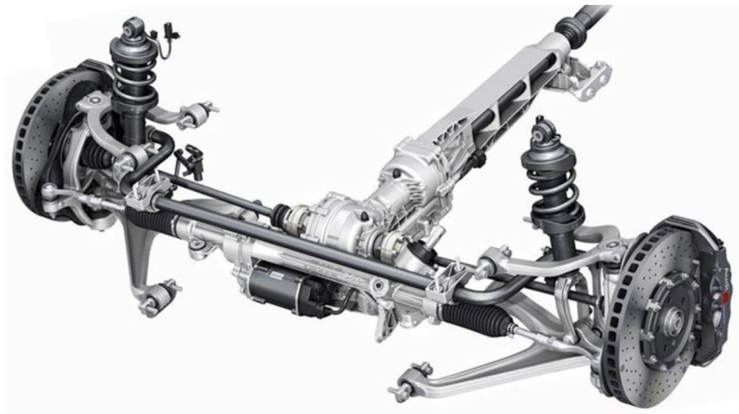
Figura 2 - 5 Suspensión de triángulos superpuestos. [22]
