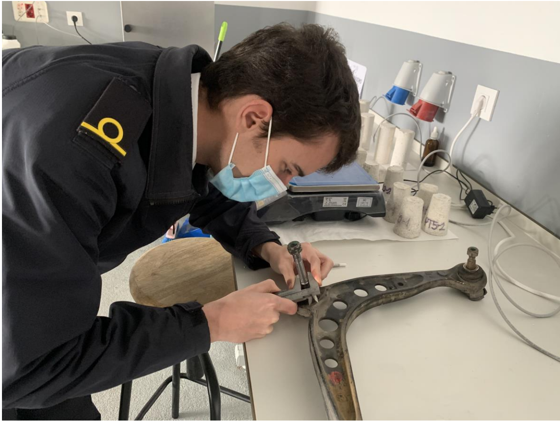
Figura 3 - 3-7 Toma de medidas sobre brazo de suspensión original desmontado, haciendo uso de un pie de rey.
