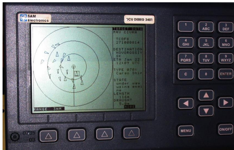
Figura 2-27 Un equipo dotado de AIS muestra la distancia y el rumbo de los barcos cercanos en un formato similar al radar [44]
