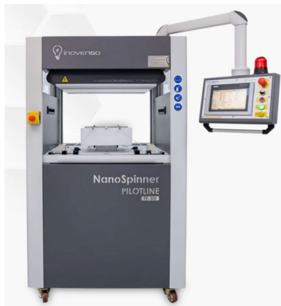
Figura 2-23: Sistema de electrospinning de agujas múltiples [43].
