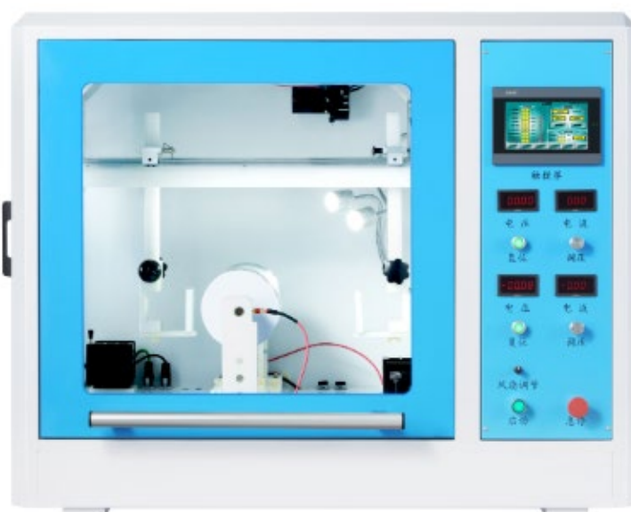
Figura 2-25: Sistema coaxial de electrospinning [45]
