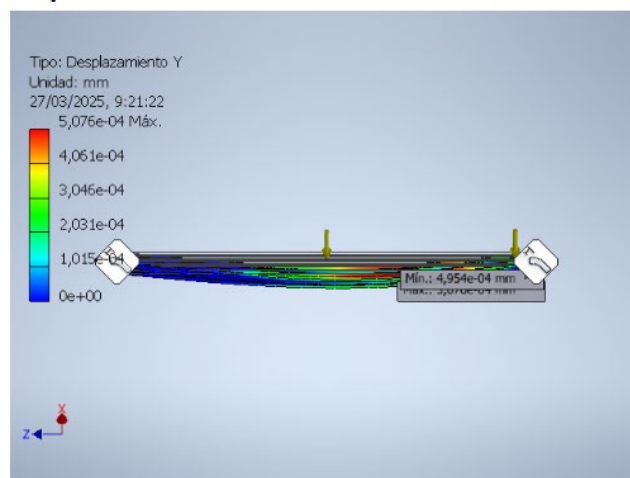
Figura 4-30: Desplazamiento en el eje Y
