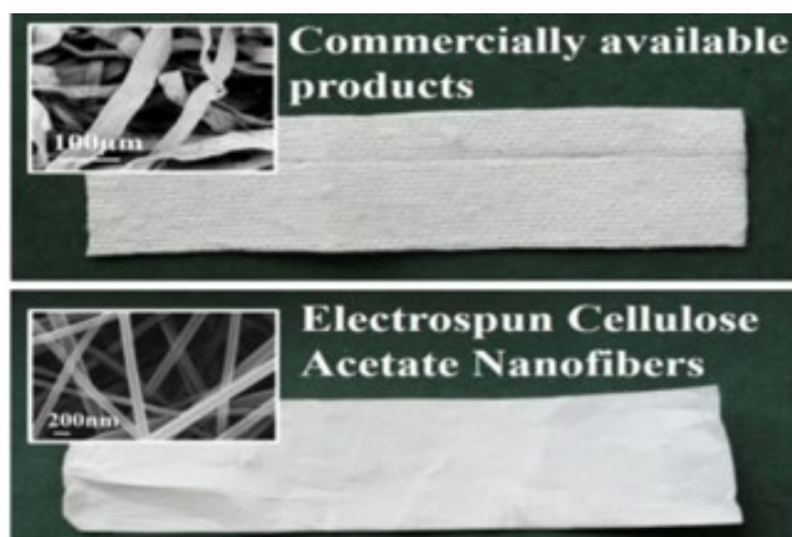
Figura 2-21: Compresas más baratas fabricadas por nanofibras y electrospinning [40].
