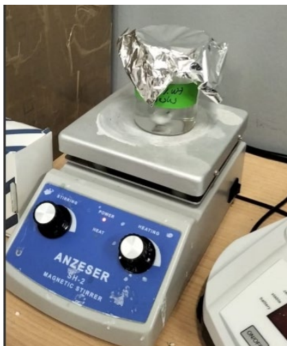
Figura 5-4: Solución de PCL y acetona en el agitador magnético del laboratorio del CUD-ENM
