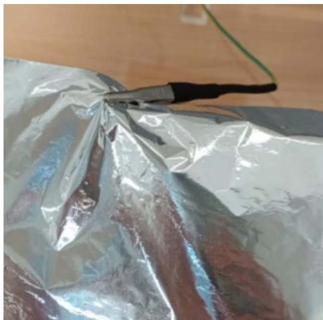
Figura 3-6: Contraelectrodo con papel de aluminio
