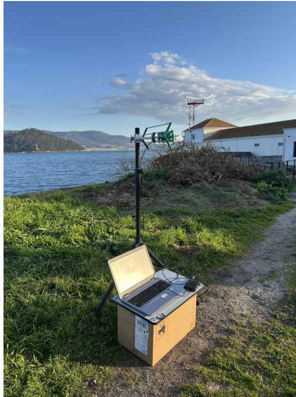
Figura 4-12. Transmisor de referencia para calibrar el array.
