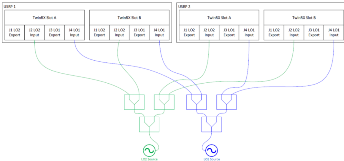
Figura 3-9 Modificación hardware para compartición de LO [25].
