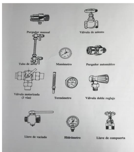
Figura 3-4. Elementos auxiliares en una instalación. Fuente [8]
