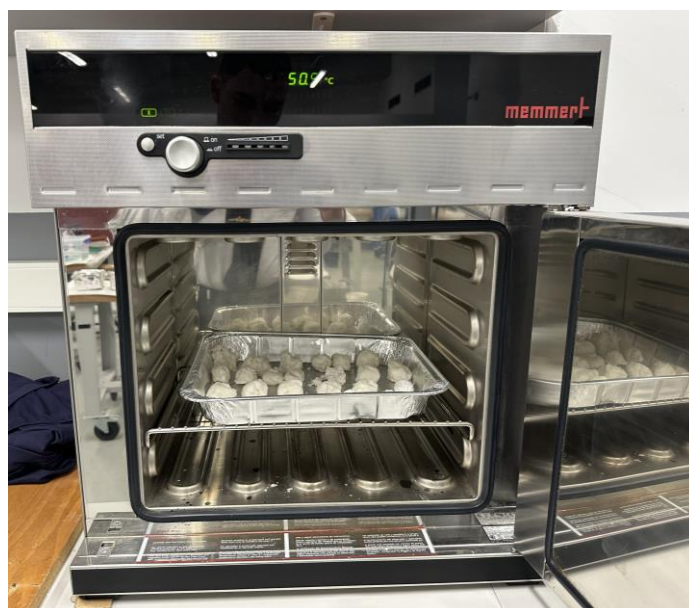
Figura 3-13 Muestras en la estufa de laboratorio a 50°C para la eliminación de humedad residual (Elaboración propia)
