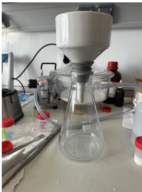
Figura 3-15 Dispositivo de filtración al vacío utilizado para la separación de las partículas sólidas y la obtención de la disolución que contiene las sales extraídas de la muestra (Elaboración propia)
