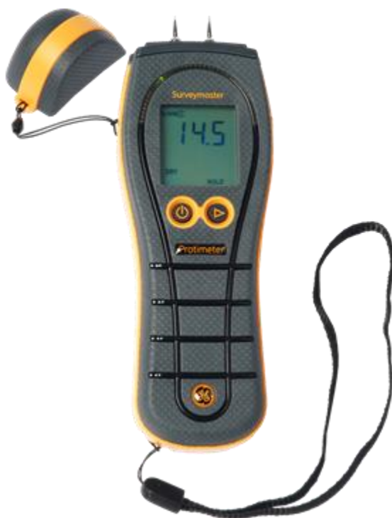
Figura 3-7 Protimeter Surveymaster empleado para la medición de humedad en el paramento estudiado (Extraído de [35])
