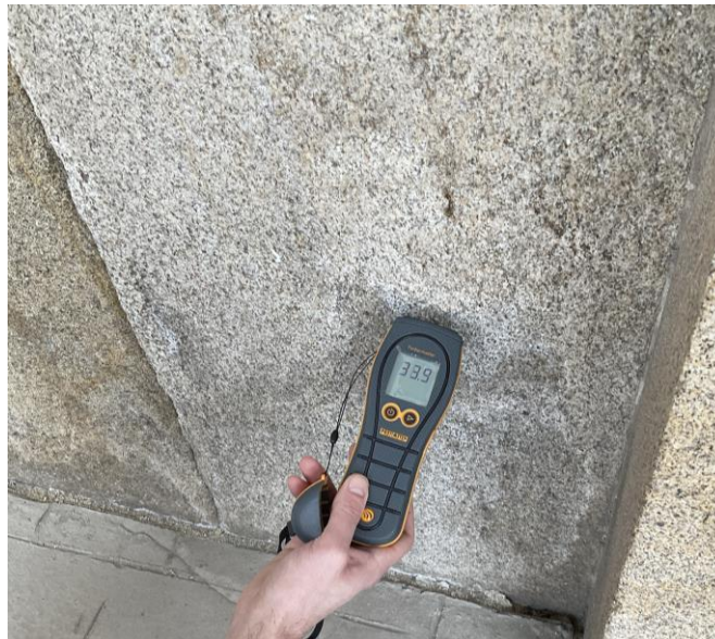
Figura 3-9 Medición de humedad superficial en el paramento mediante higrómetro portátil durante la campaña de adquisición de datos (Elaboración propia)
