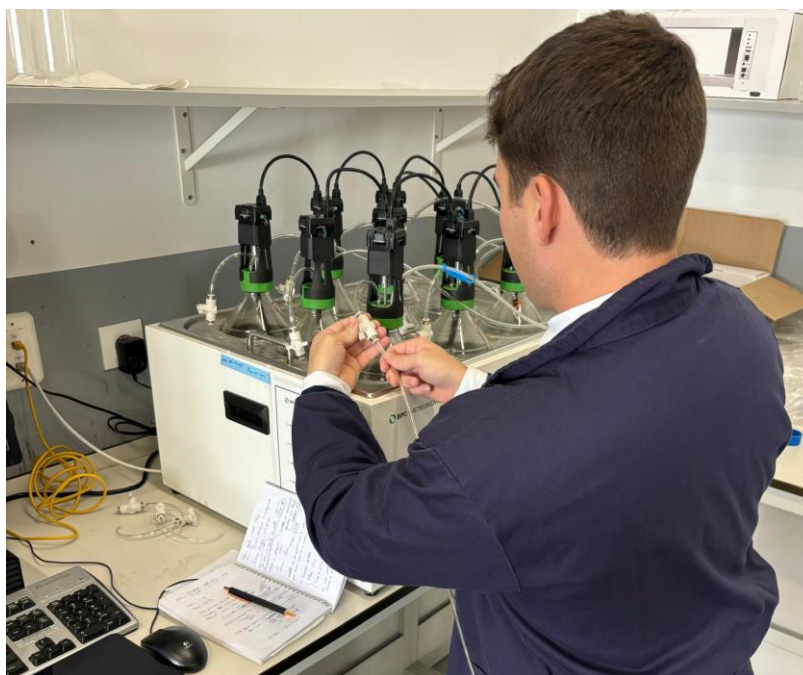
Figura 3-8 Inyección manual de nitrógeno para purgar el oxígeno (elaboración propia).
