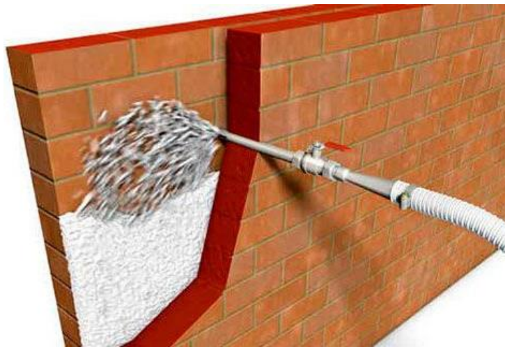
Figura 2-13. Inyección de barrera hidrofugante.
