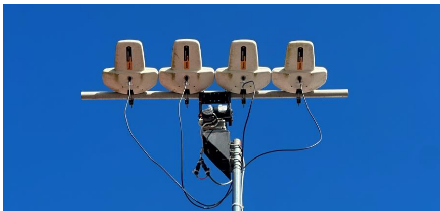
Figura 3-17: Array de antenas receptoras.
