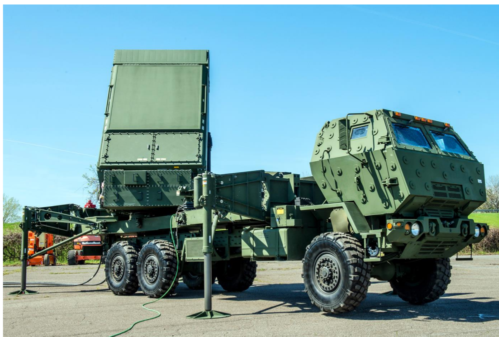
Figura 2-3: MFCR (Multifunction Fire Control Radar) como sistema monoestático [8].
