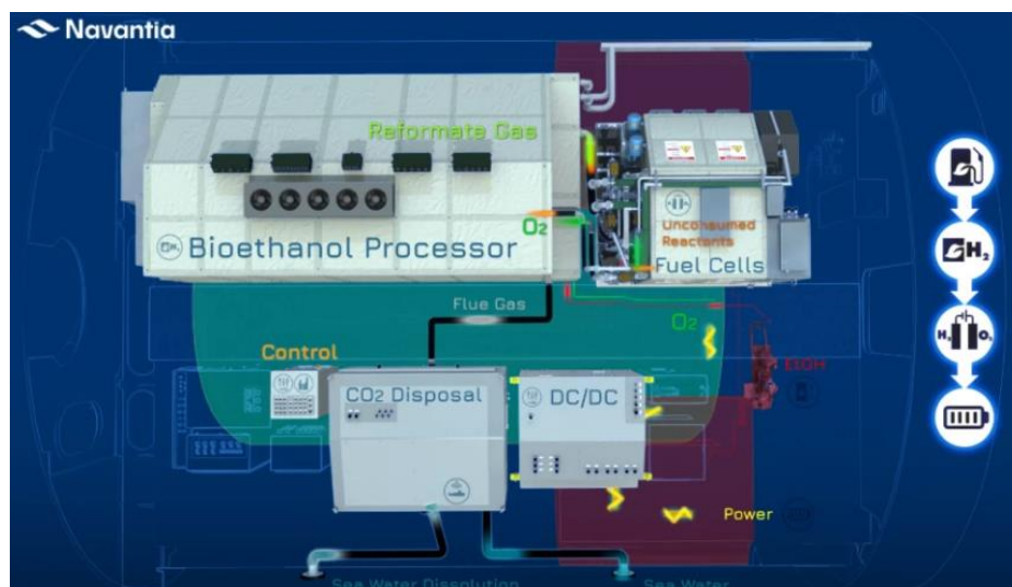
Figura 2-7 Sistema AIP Submarinos S-80 [16].
