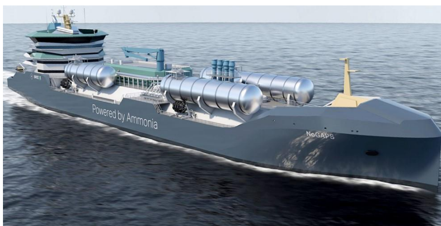
Figura 2-20 Potencial diseño de buque propulsado por amoníaco [50].
