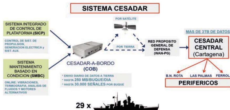
Figura 2-1 Esquema del sistema CESADAR actual. Fuente: [5].
