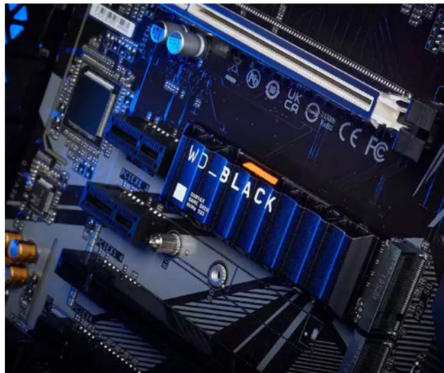
Figura 2-2. Disipador de calor en un disco SSD. [6]
