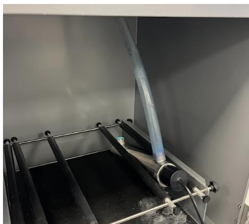
Figura 3-9 Montaje del experimento UV/ H_2O_2
