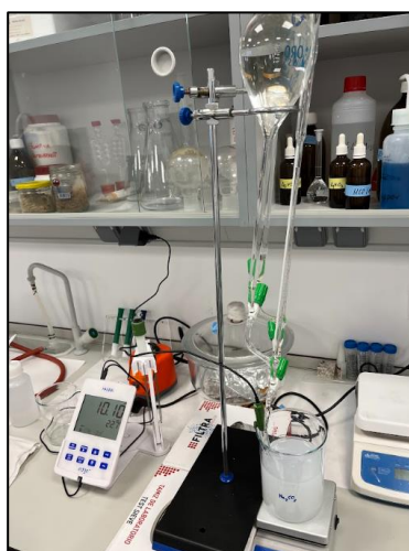
Figura 3-2 Montaje de estación de goteo para formación de la hidrotalcita
