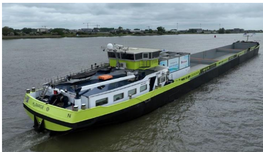
Figura 5-5 H 2 Barge 1, primer carguero fluvial propulsado por hidrógeno [84]
