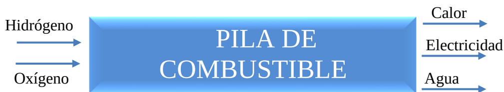
Figura 5-2 Entradas y salidas en una pila de combustible de hidrógeno
