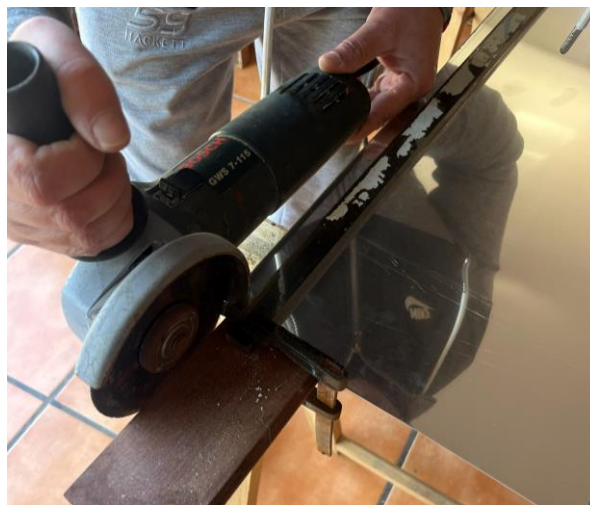
Figura 3-13 Corte del Aluminio con amoladora angular.
