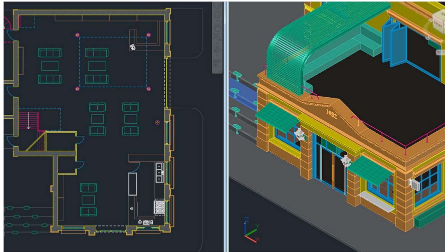
Figura 2-8 Dibujo 2D y modelado 3D en AutoCAD [23]
