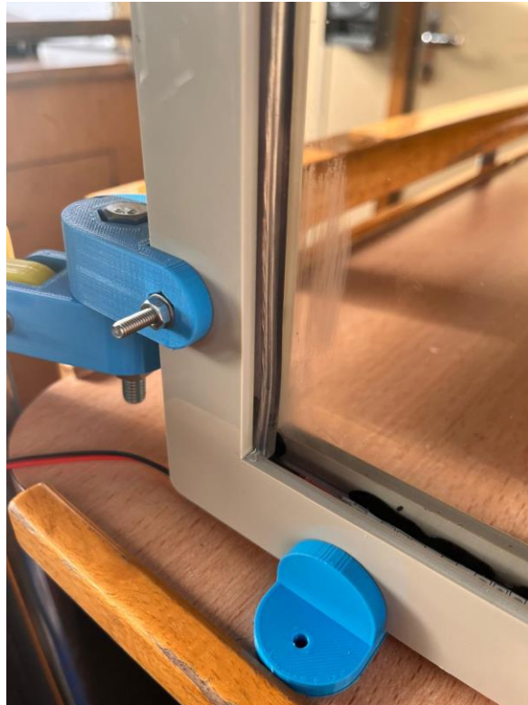
Figura 4-5 Detalle de esquina inferior, donde se apoya la pizarra sobre el soporte [Autoría propia]
