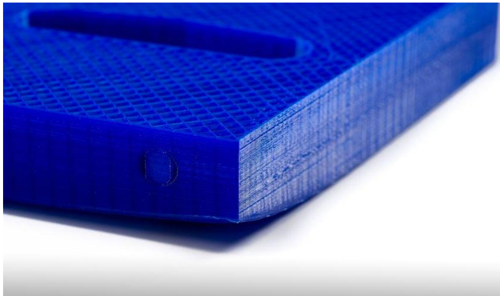
Figura 2-3 Figura afectada por warping [9]
