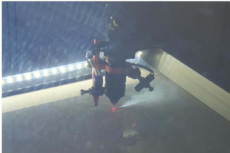
Figura 3-5 Cortado láser de la plancha de polipropileno gris [Autoría propia]
