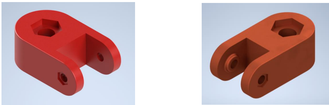
Figura 3-3 Bisagras, a pizarra (izquierda) y a abrazadera (derecha) [Autoría propia]
