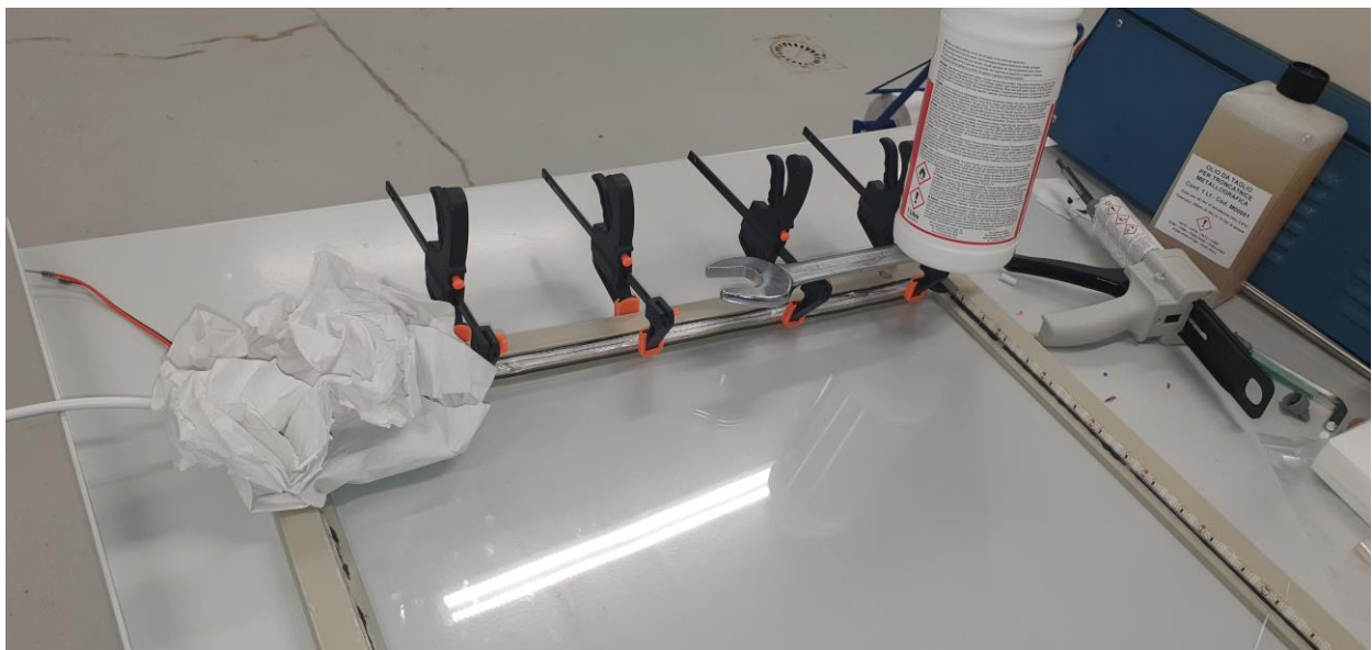
Figura 3-11 Pegado de luces LED. Las rojas, con IP66 con recubrimiento plástico. [Autoría propia]
