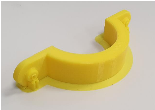
Figura 3-7 Abrazadera posimpresión con cama (izda) y con su homóloga limpia (dcha) [Autoría propia]
