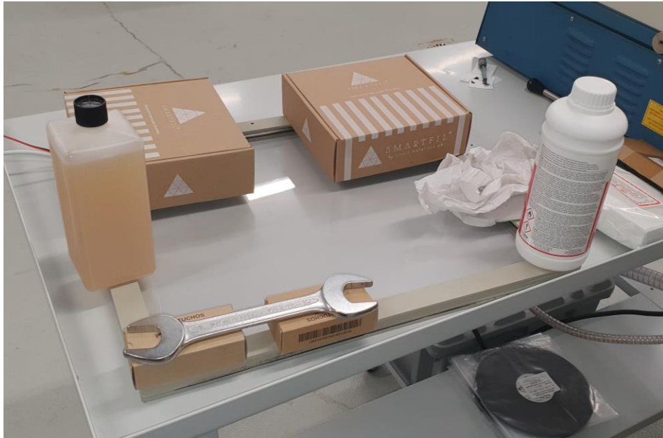
Figura 3-12 Colocación de pesos tras el pegado del segundo marco exterior durante el secado de la resina [Autoría propia]
