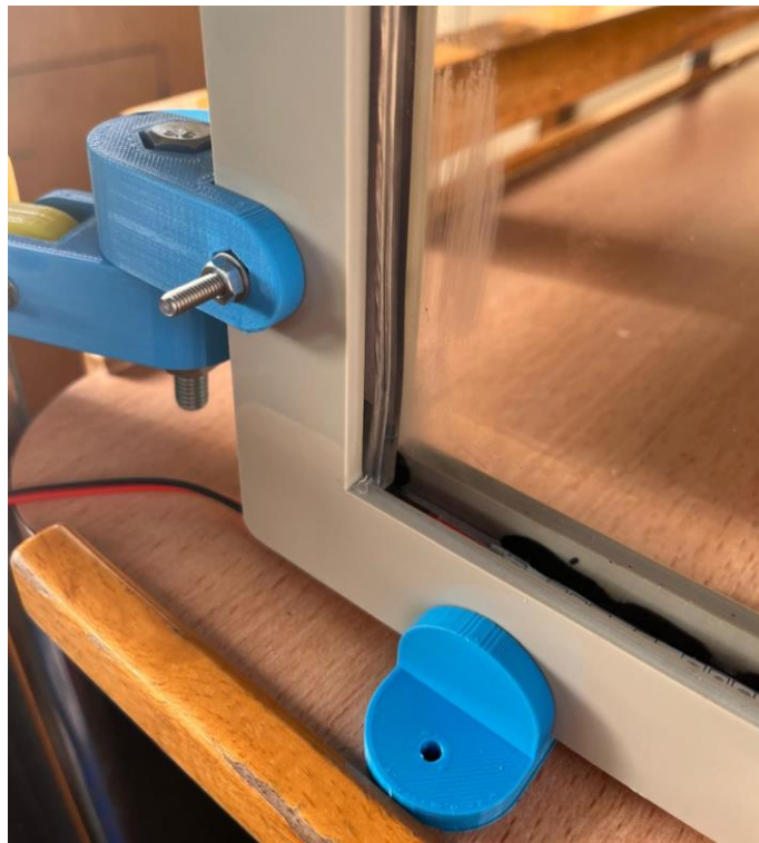
Figura 3-15 Bisagra y soporte inferiores, previamente a la fijación con tornillos del último [Autoría propia]
