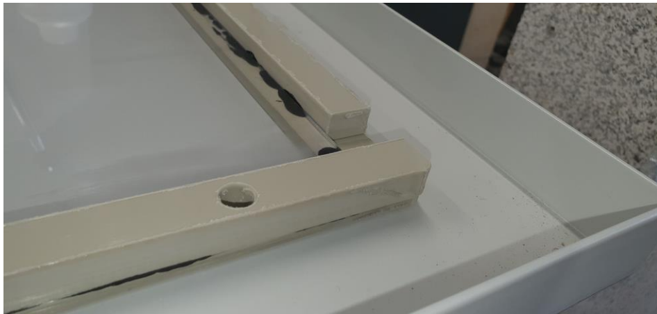
Figura 3-10 Pegado de panel y marcos con la resina, en negro [Autoría propia]
