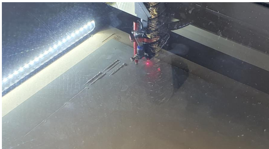
Figura 3-6 Trazas de los ensayos previos al corte [Autoría propia]
