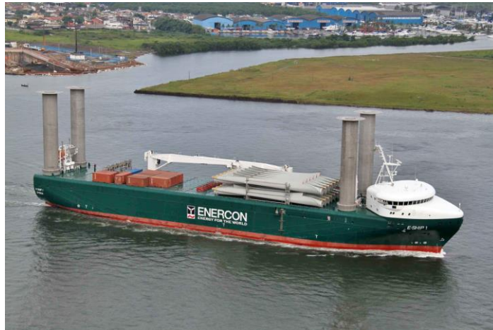
Figura 2-26 E-Ship 1 con rotores Flettner [24]
