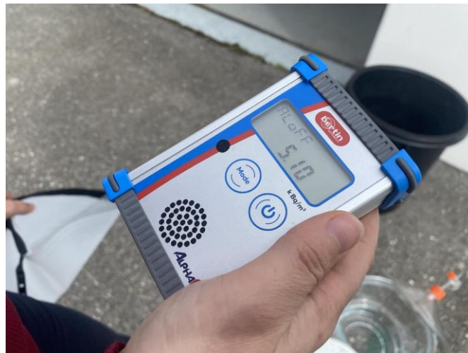
Figura 3-7 Medidor de Radón empleado en ensayos
