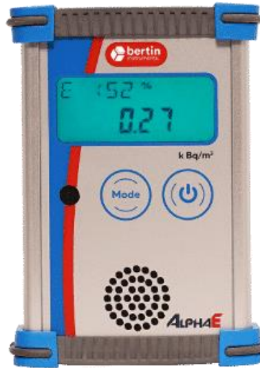
Figura 3-6 Medidor de Radón empleado en ensayos
