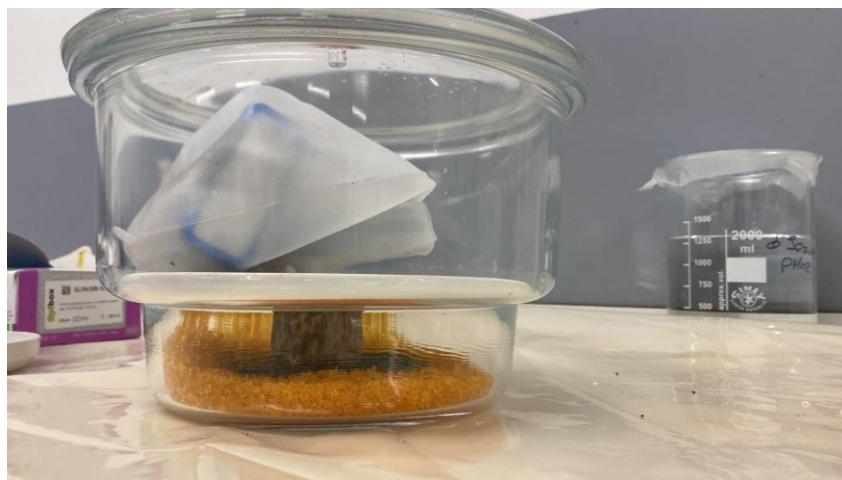
Figura 3-8 Montaje Desorción con gel de Sílice (elaboración propia)
