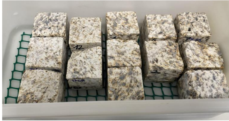
Figura 3-2 Muestra de ensayo inmersión parcial
