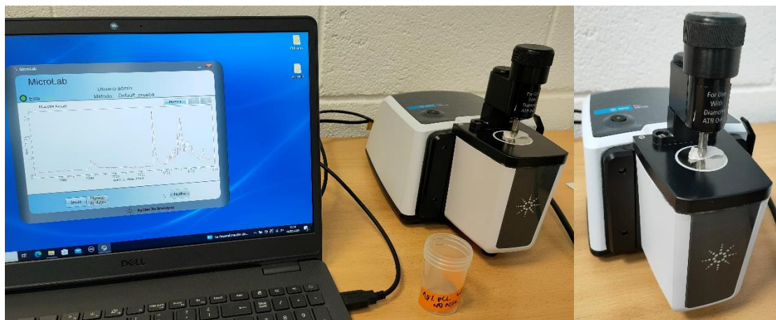
Figura 3-32 Sistema de caracterización FTIR. Cortesía Laseron (Uvigo)
