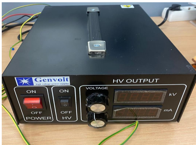
Figura 3-6 Fuente generadora de alta tensión
