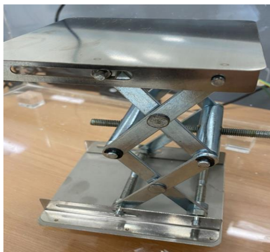
Figura 3-13 Sistema de posicionamiento vertical
