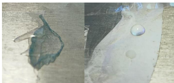
Figura 4-22 Ensayo de la gota con fibras de PCL dopadas con algas (izquierda) y sin dopar (derecha)
