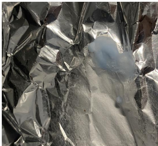
Figura 4-6 Ensayo PCL 80000, 25 kV
