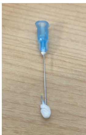
Figura 4-5 Taponamiento del fluido en electrodo
