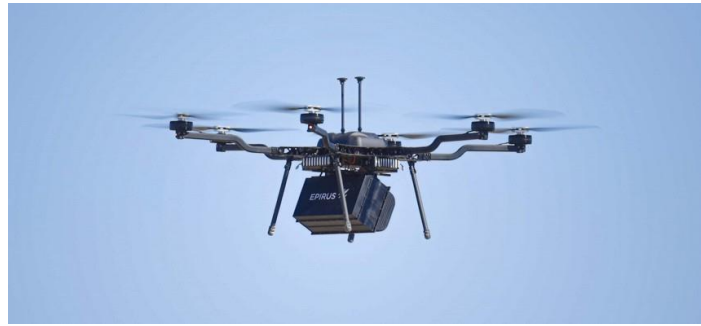
Figura 2-4 Ejemplo de un sistema microondas en un dron [11]
