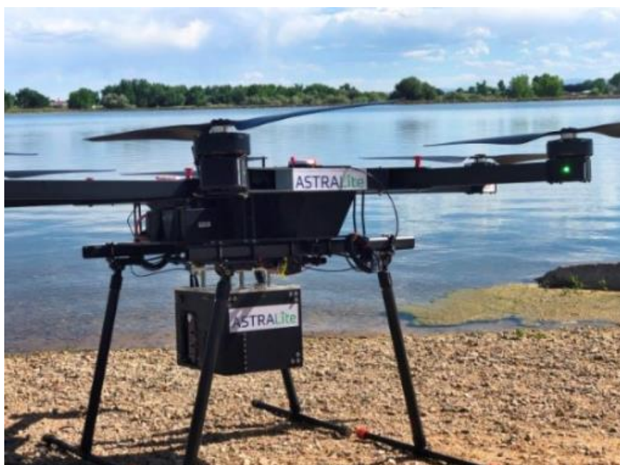
Figura 3-7 ASTRALite montado en RPAS. Obtenido de [47]
