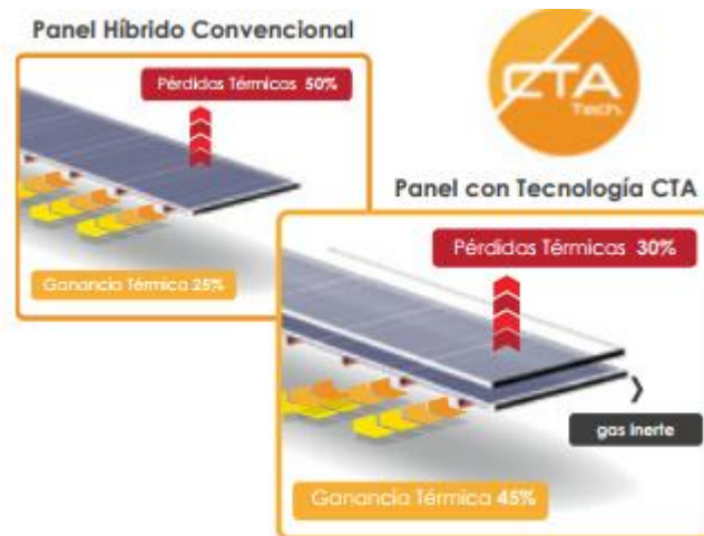
Figura 2-11 Diferencia de un panel híbrido con tecnología CTA [19]
