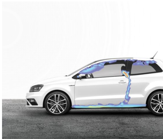
Figura 2-39: Medición parámetro velocidad de partícula para evaluar la estanqueidad de un vehículo ([44])
