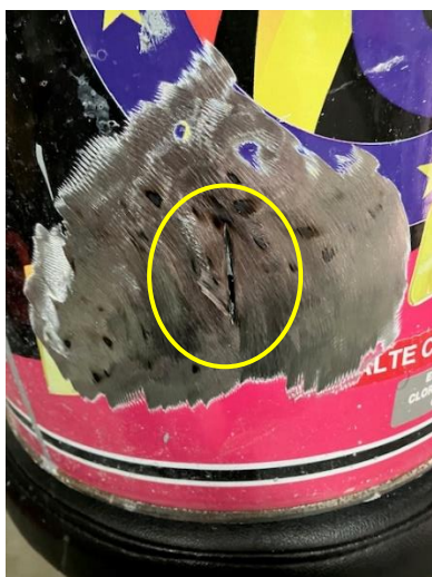
Figura 3-6: Grieta realizada en el cubo. (Elaboración propia).
