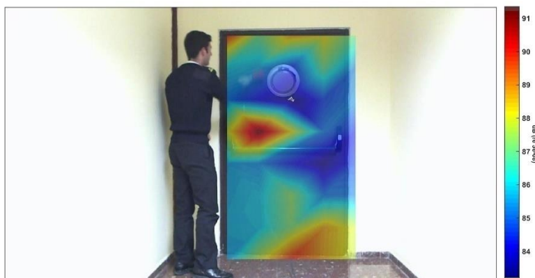
Figura 3-11: Velocidad de partícula empleando el método de cuadrícula. (Elaboración propia).
