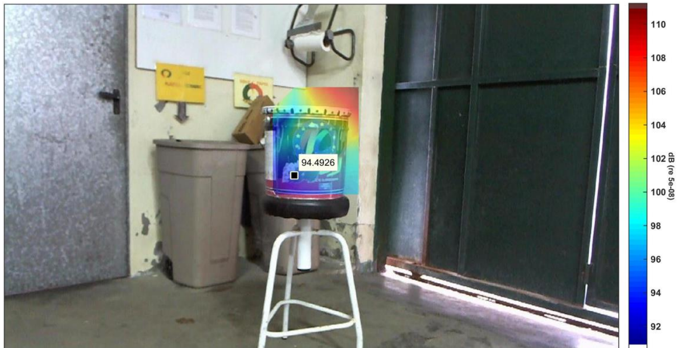
Figura 3-25: Velocidad de partícula en cubo con reducción de espesor. (Elaboración propia).
