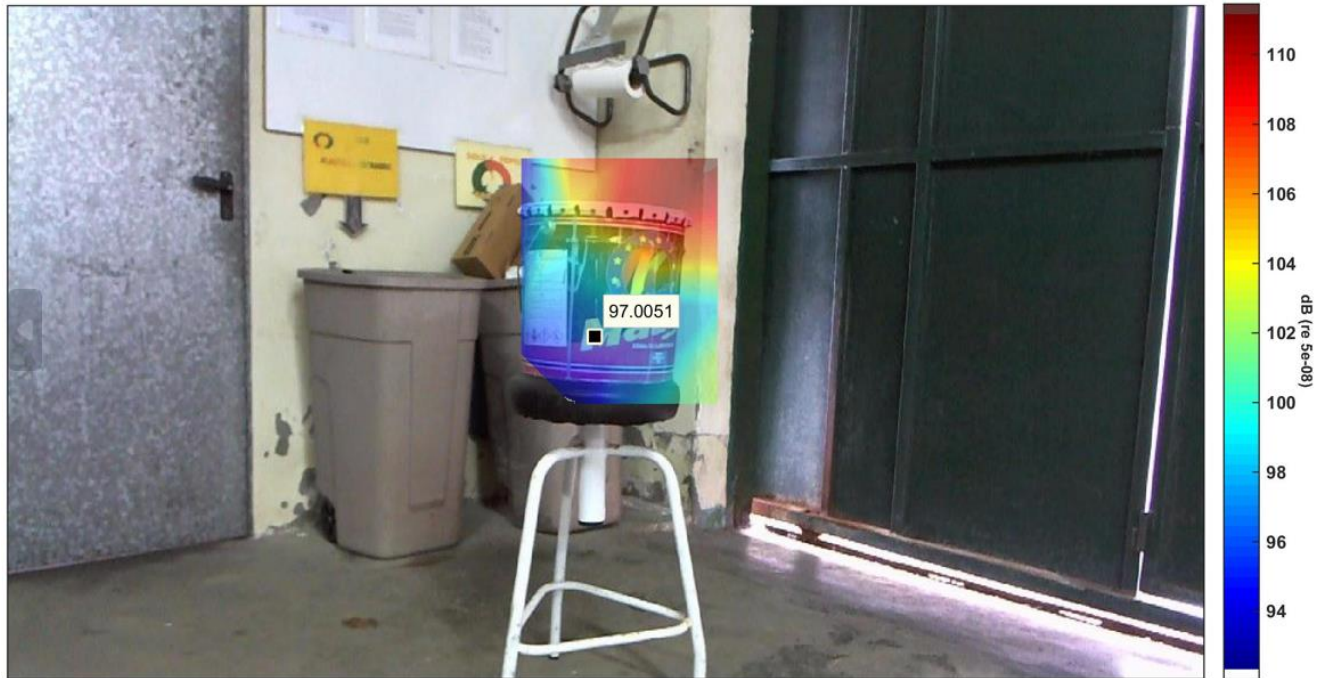
Figura 3-24: Velocidad de partícula en cubo sin reducción de espesor. (Elaboración propia).
