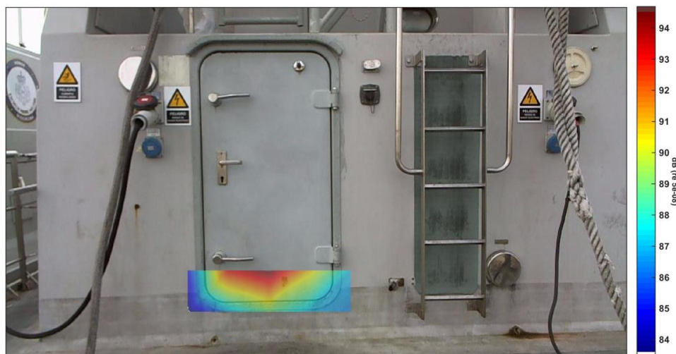
Figura 3-33: Velocidad de partícula con método de punto. (Elaboración propia).
