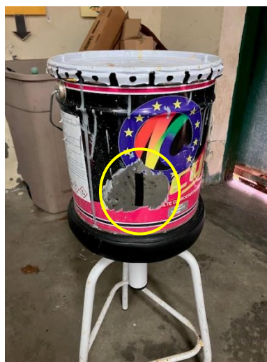
Figura 3-7: Grieta taponada con cinta aislante. (Elaboración propia).
