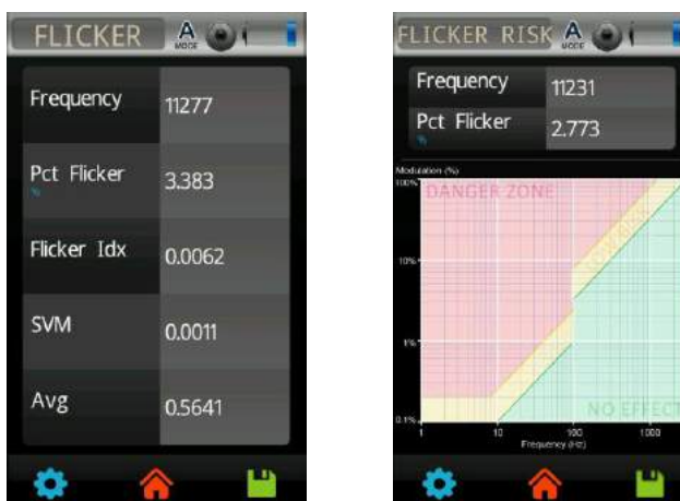
Figura 4-33 Análisis del parpadeo del downlight de LDV Lighting (realizado con el espectrómetro MK350S PREMIUM)
