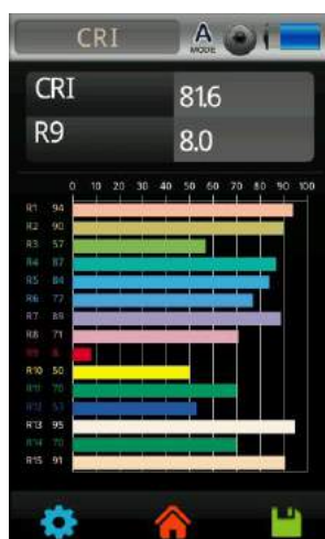
Figura 4-2 Análisis del IRC de la luminaria LIFEMAX (realizado con el espectrómetro MK350S PREMIUM)
