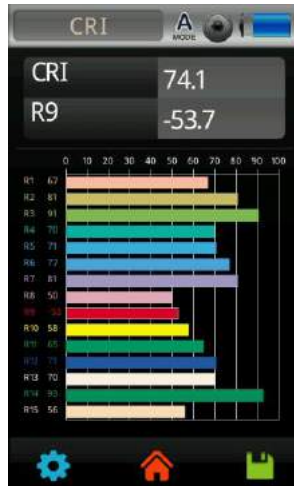
Figura 4-4 Análisis del IRC de la luminaria MASTER (realizado con el espectrómetro MK350S PREMIUM)
