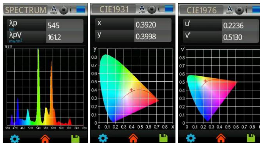
Figura 4-5 Análisis del espectro de la luminaria OSRAM (realizado con el espectrómetro MK350S PREMIUM)
