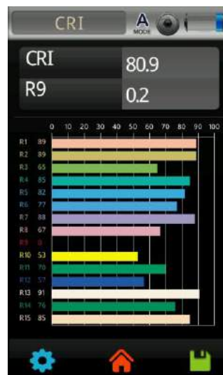
Figura 4-27 Análisis del IRC del panel LDV Lighting (realizado con el espectrómetro MK350S PREMIUM)
