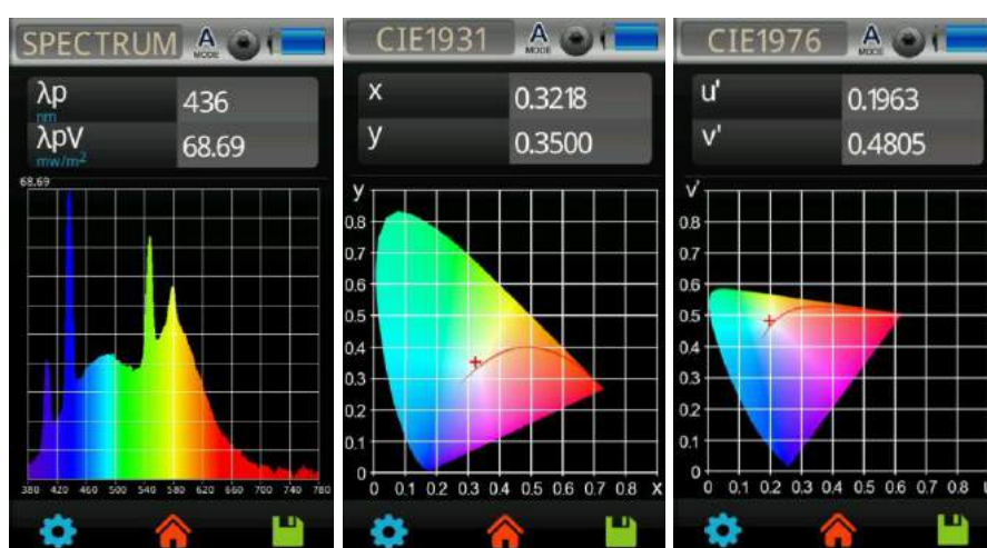
Figura 4-3 Análisis del espectro de la luminaria MASTER (realizado con el espectrómetro MK350S PREMIUM)
