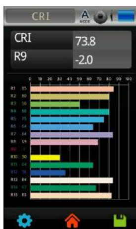
Figura 4-6 Análisis del IRC de la luminaria OSRAM (realizado con el espectrómetro MK350S PREMIUM)
