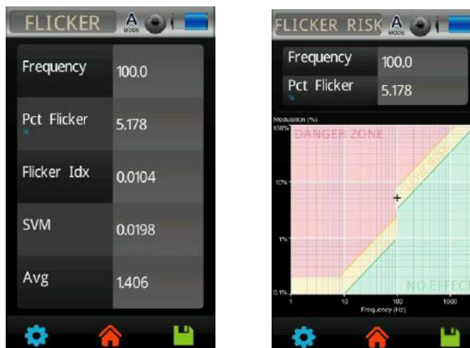
Figura 4-12 Análisis del parpadeo de OSRAM DULUX D 26/830 (realizado con el espectrómetro MK350S PREMIUM)
