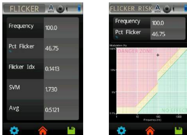
Figura 4-32 Análisis del parpadeo del panel de LDV Lighting (realizado con el espectrómetro MK350S PREMIUM)
