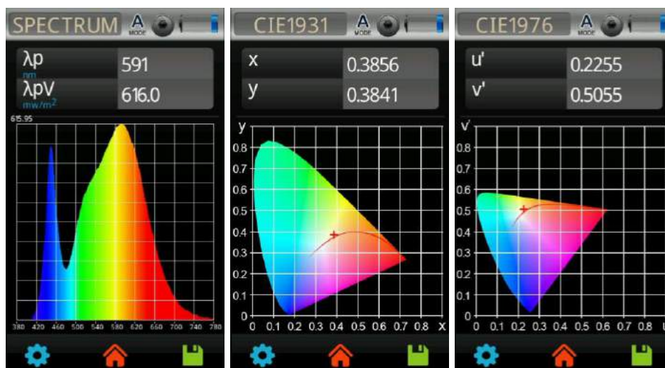
Figura 4-28 Análisis del espectro del downlight LDV Lighting (realizado con el espectrómetro MK350S PREMIUM)
