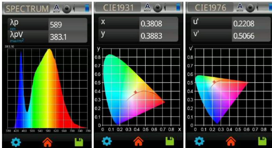
Figura 4-26 Análisis del espectro del panel LDV Lighting (realizado con el espectrómetro MK350S PREMIUM)
