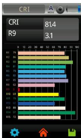
Figura 4-29 Análisis del IRC del downlight LDV Lighting (realizado con el espectrómetro MK350S PREMIUM)
