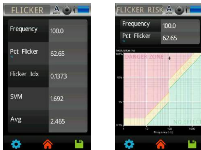
Figura 4-11 Análisis del parpadeo de MASTER TL-D Super 80 (realizado con el espectrómetro MK350S PREMIUM)
