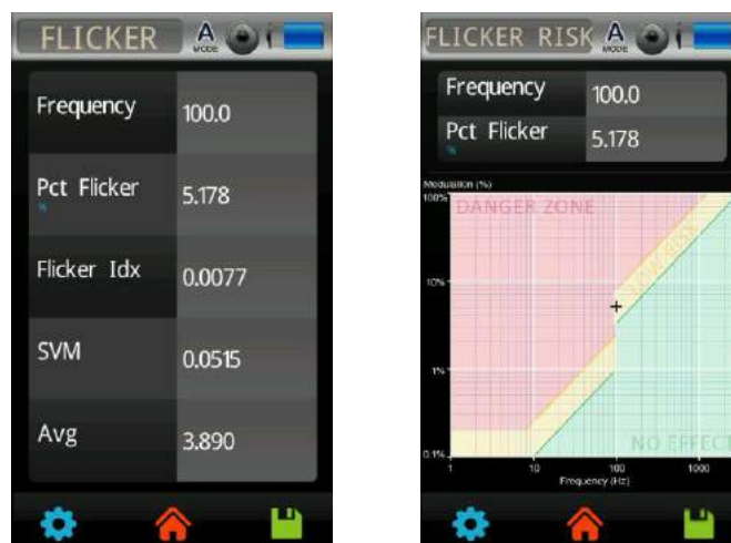
Figura 4-10 Análisis del parpadeo de LIFEMAX Super 80 JIS (realizado con el espectrómetro MK350S PREMIUM)
