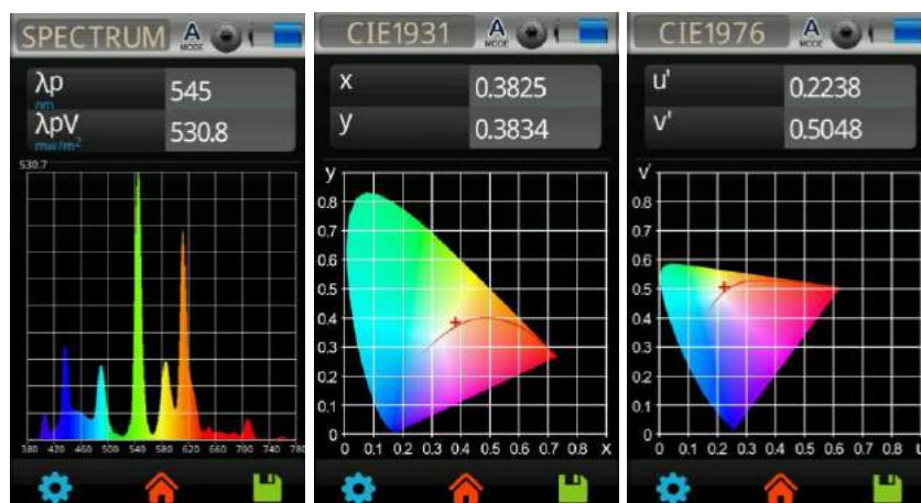
Figura 4-1 Análisis del espectro de la luminaria LIFEMAX (realizado con el espectrómetro MK350S PREMIUM)
