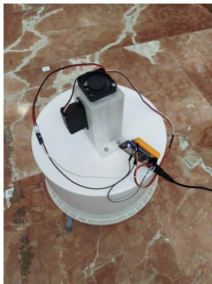
Figura 3-10 Montaje del dispositivo de ventilación
