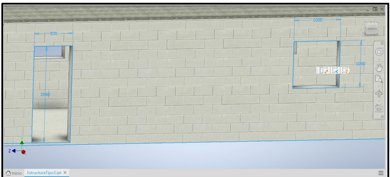
Figura 3-32 Extrusión de puertas y ventanas. (Autoría propia)
