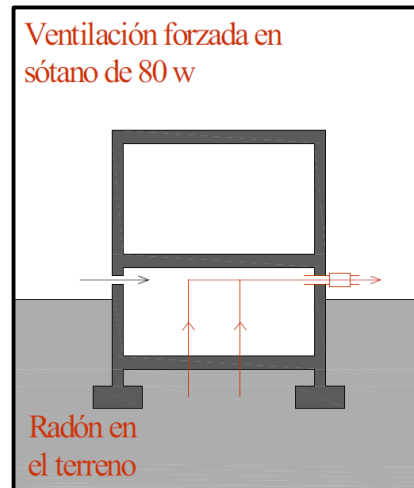
Figura 2-9 Extracción forzada en sótano [28]
