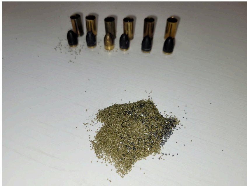
Figura 3-9 Cartuchos desmontados y pólvora seca (fuente propia)
