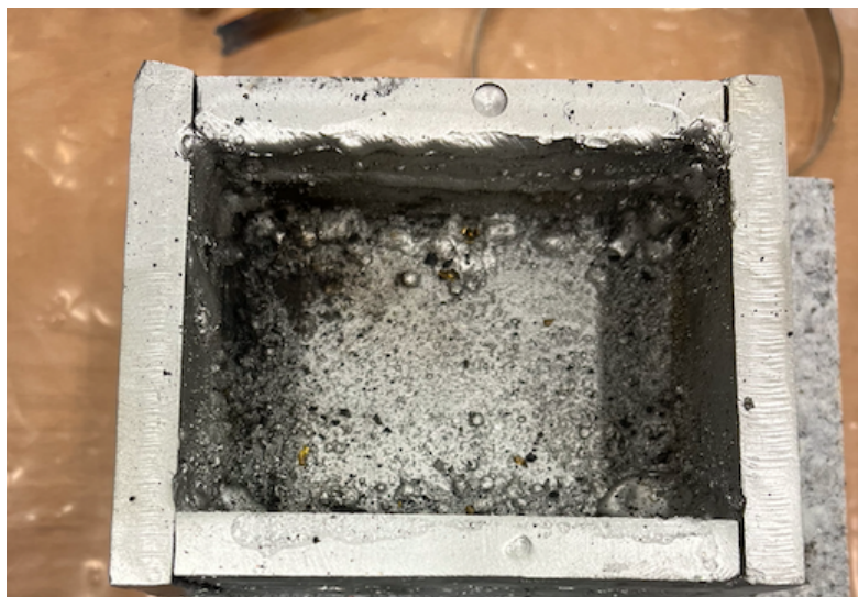
Figura 3-12 Sarcófago terminado con capa de Zinc (fuente propia)
