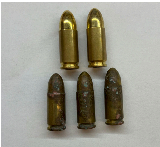
Figura 3-3 Comparación Cartuchos degradados por agentes externos y cartuchos en perfecto estado(fuente propia)
