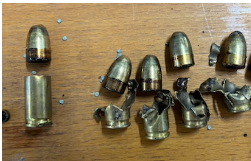
Figura 4-1 Estado de los cartuchos tras detonar (fuente propia)
