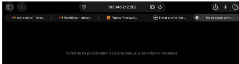
Figura 4-6: Prueba de acceso externo a Open WebUI bloqueada por la configuración del firewall
