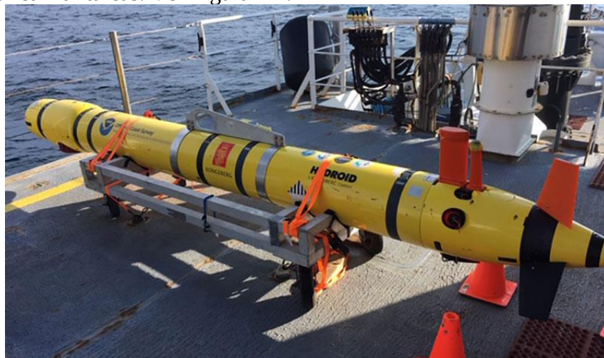
Figura 2-4 AUV modelo REMUS 600 en la cubierta del barco de NOAA [15].
