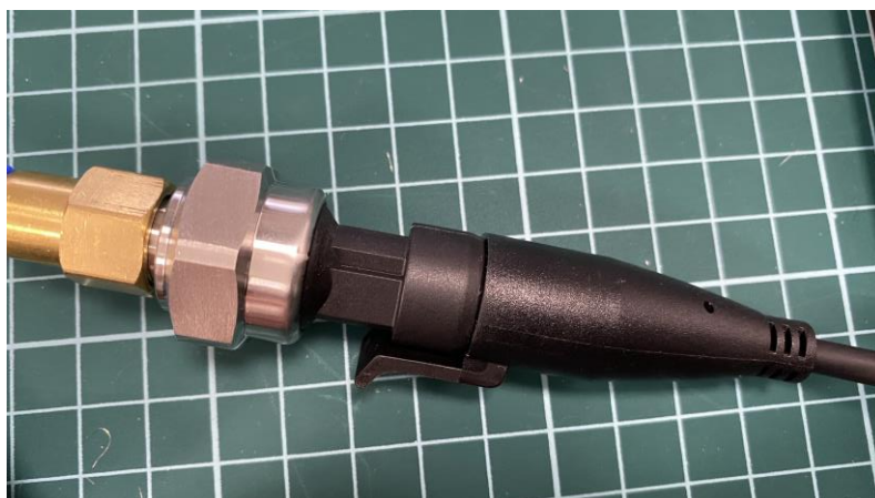
Figura 3-14 Transductor de presión, Akozon Sensor de presión de acero inoxidable.
