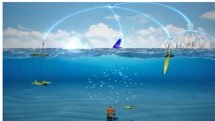
Figura 2-7 El UUV está enviando los datos a través del satélite de la estación en tierra [19].
