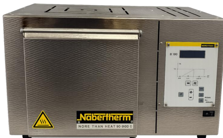
Figura 3-12: Horno de mufla compacto LE 14 / 11. Nabertherm. Controlador B150.
