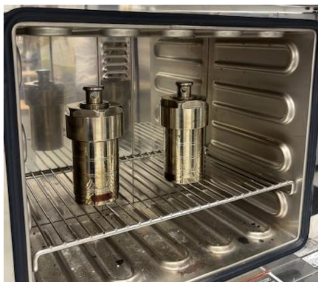
Figura 3-5: Reactor HTC en estufa de marca Memmert a 200 °C.
