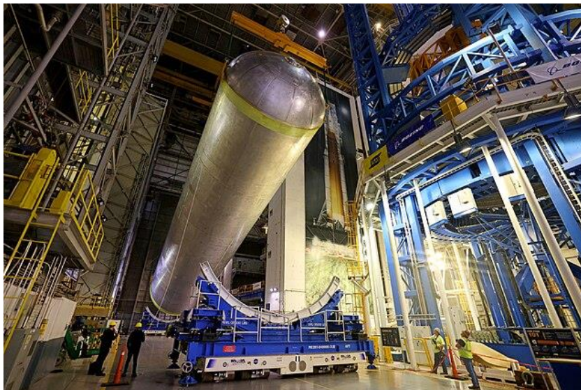
Figura 2-2: Tanque criogénico de hidrógeno líquido empleado en aplicaciones aeroespaciales, ejemplo de los requisitos tecnológicos asociados al almacenamiento en condiciones extremas. Fuente: [NASA/Michael DeMocker]
