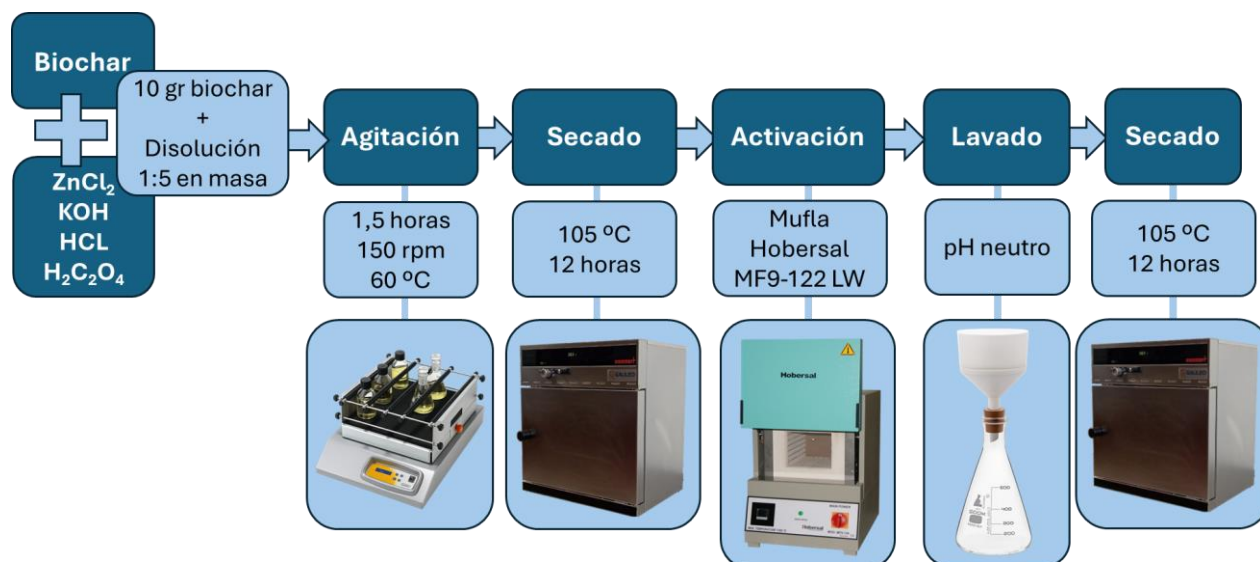
Figura 3-8: Esquema general del procedimiento de activación del biochar.
