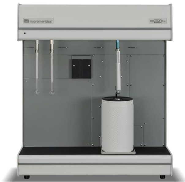
Figura 3-14: Analizador de adsorción de gases ASAP 2020 (Micromeritics) empleado en la determinación de propiedades texturales mediante el método BET [88].
