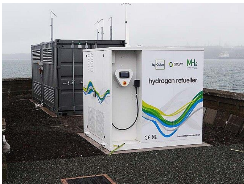
Figura 2-5: Estación de repostaje de hidrógeno comprimido para aplicaciones de transporte. Fuente: [Wikimedia Commons].
