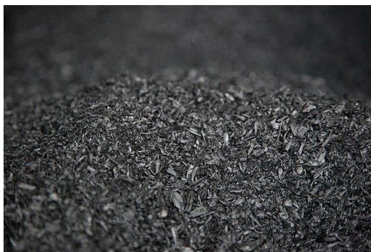
Figura 2-8: Biochar obtenido a partir de biomasa leñosa, ejemplo de material carbonoso con potencial para la valorización de residuos orgánicos en aplicaciones de adsorción. Fuente: [Wikimedia Commons]
