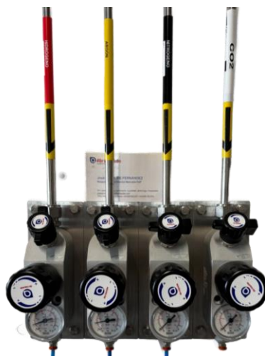
Figura 3-16: Sistema de suministro y control de gases empleado durante los ensayos termogravimétricos.
