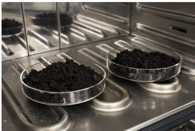
Figura 3-6: Proceso de secado de biochar a 105 °C durante 24 horas.
