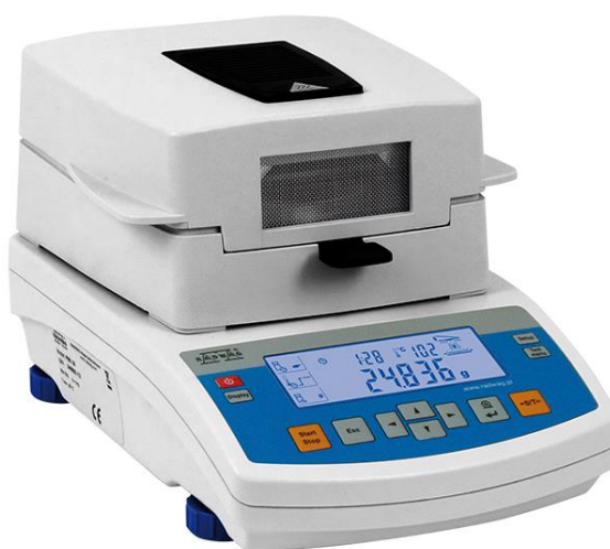
Figura 3-11: Analizador de humedad Radwag PMC.
