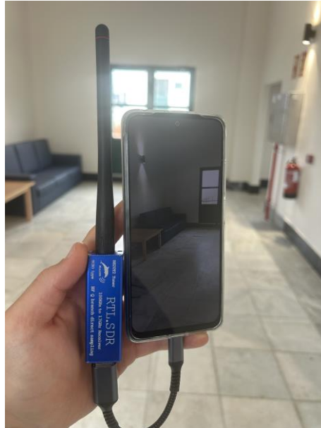
Figura 3-6 Dispositivo móvil y antena RTL-SDR.
