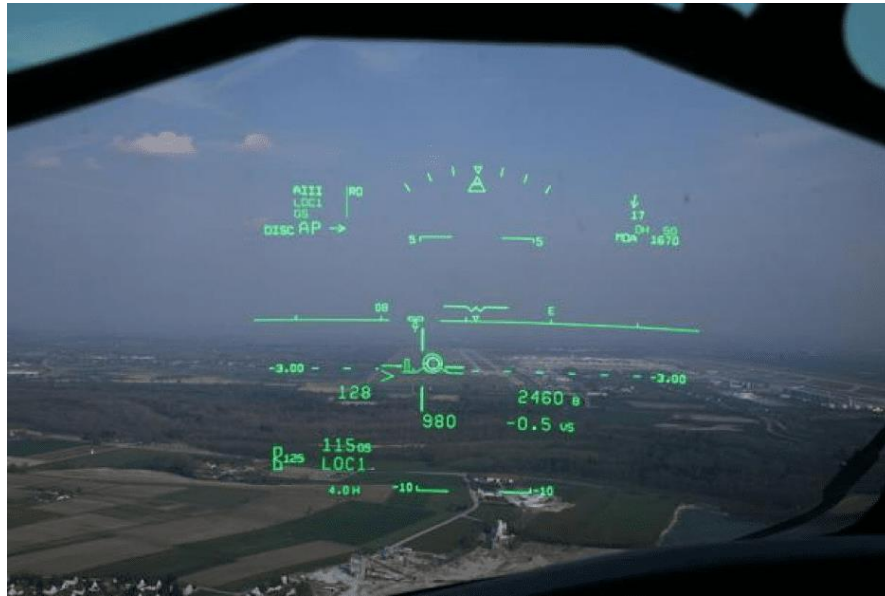
Figura 1-1 Ejemplo de HUD montado en aeronave para mostrar ayudas al vuelo [4]
