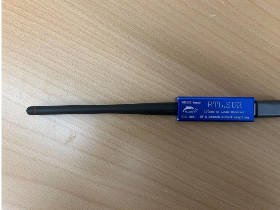
Figura 3-1 Antena conectada a la carcasa RTL-SDR con chip R820T2 y RTL2832U (Elaboración propia)
