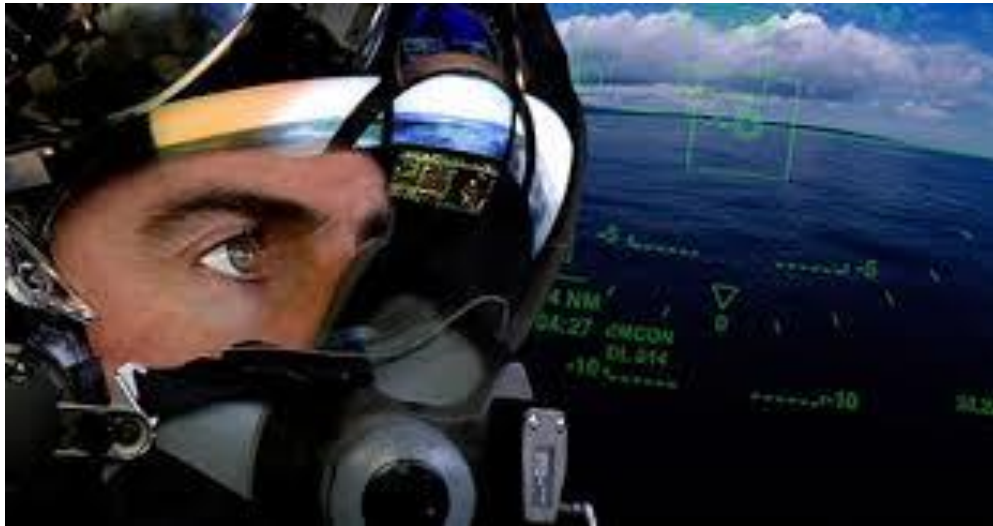
Figura 2-6 HMS combinación de la tecnología HUD con el casco de los pilotos [26]
