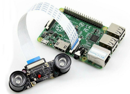
Figura 2-18 Pi NoIR, cámara para Raspberry Pi [13]
