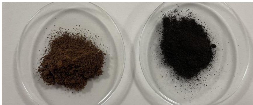
Figura 3-5 Posos de café antes del tratamiento (izquierda) y biochar producido (derecha)
