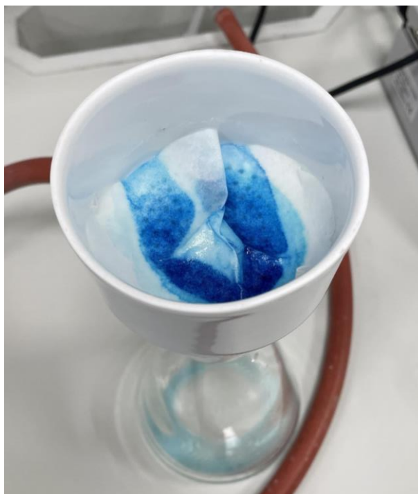
Figura 3-11 Adsorción no deseada del azul de metileno por parte del material filtrante
