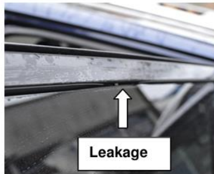
Figura 2-26 Representación de la fuga acústica artificial en la ventana trasera del vehículo ([36])
