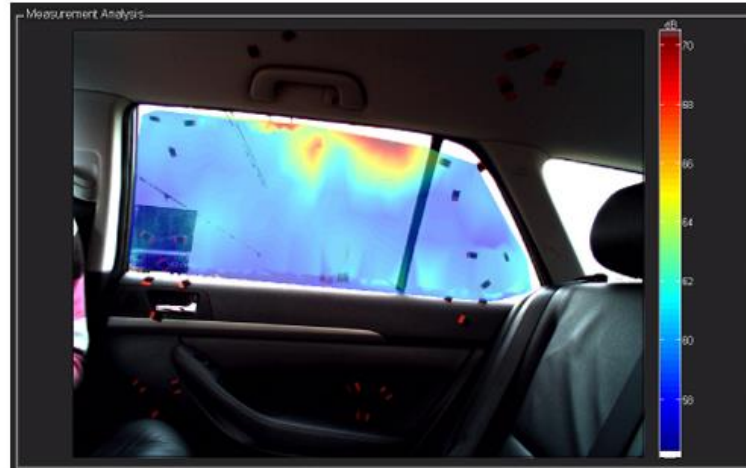
Figura 2-29 Distribución de la velocidad de partícula en el interior del vehículo con altavoz externo (200 Hz - 2 kHz) ([36])
