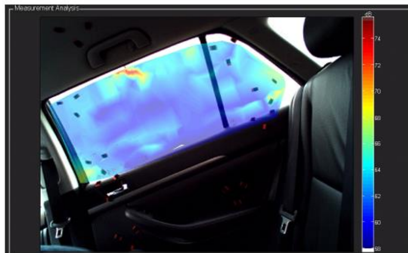
Figura 2-27 Mapa acústico a 40 km/h en el rango de 200 Hz - 2 kHz ([36])
