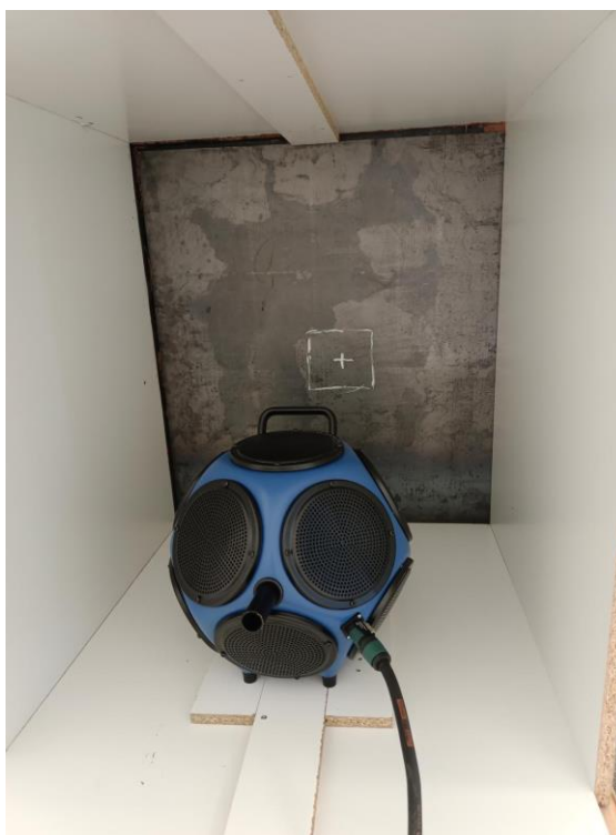
Figura 3-1 Configuración inicial de ensayo acústico en chapa sin fresado (Elaboración propia)
