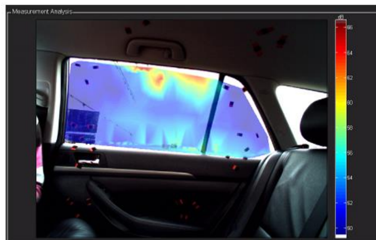
Figura 2-30 Distribución de la velocidad de partícula en el interior del vehículo con altavoz externo (2 kHz - 10 kHz) ([36])
