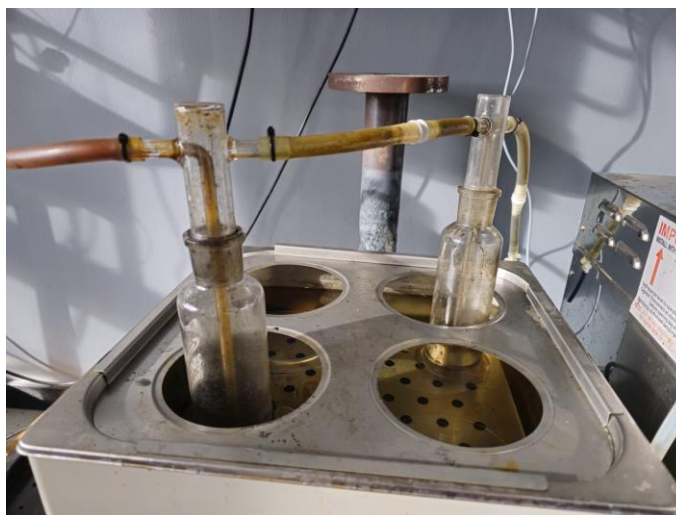
Figura 3-18 Sistema de condensación
