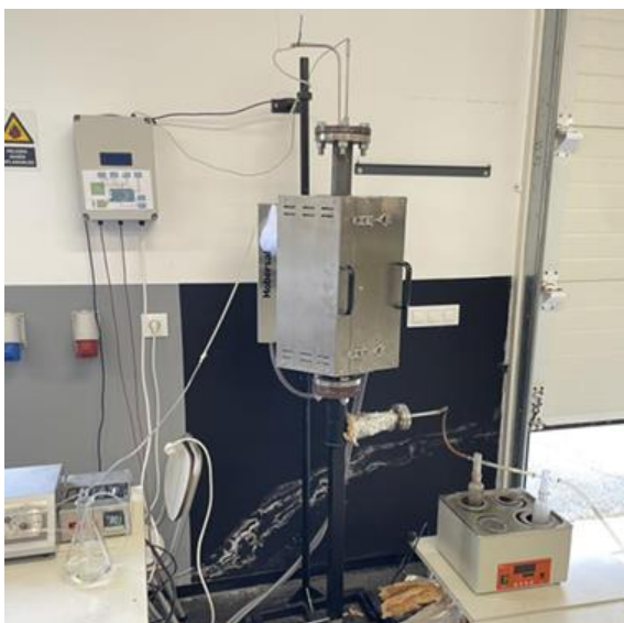
Figura 2-20 Reactor de hidrogeno del CUD
