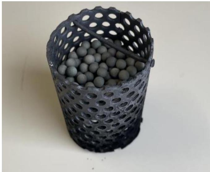
Figura 3-17 Cestilla en la que se introducen los soportes catalíticos
