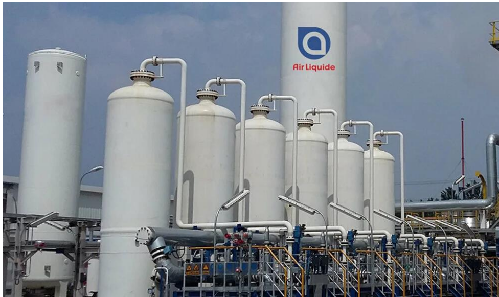
Figura 2-19 Proceso de adsorción cíclico con absorbedores [30]
