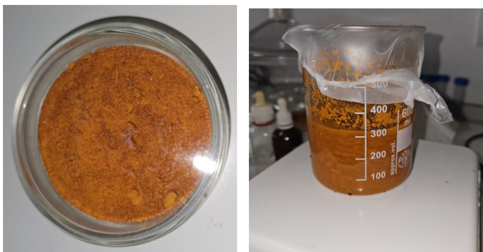
Figura 3-4 Ferroceno en polvo en placa Petri para proceso de pesado (derecha) y proceso de mezclado de la disolución mediante agitación mecánica en placa magnética (izquierda)
