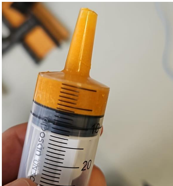
Figura 3-21 Jeringa de impulsión atascada por ferroceno precipitado
