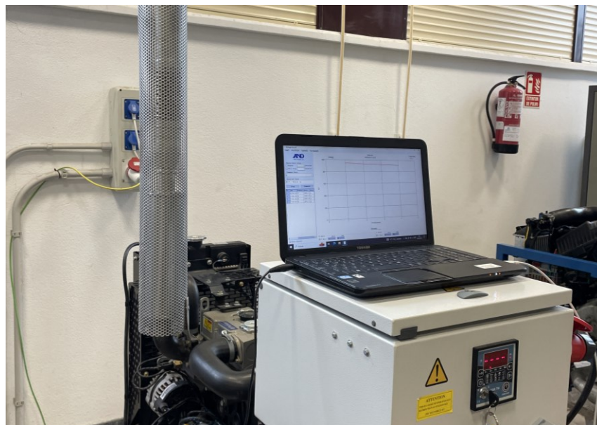
Figura 3-25 Sistema de medición del estudio de consumo (fuente propia)
