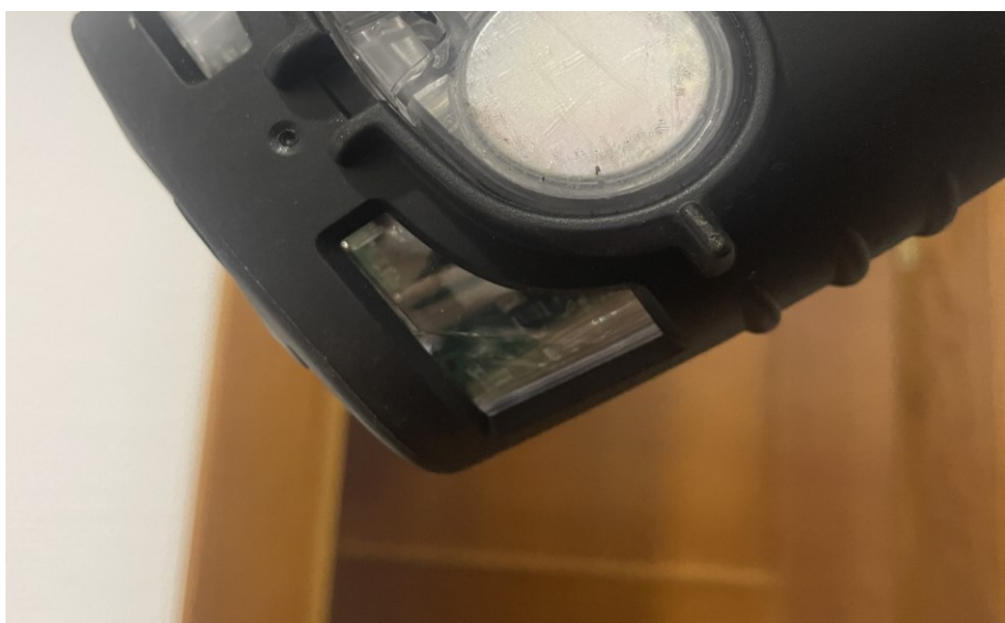
Figura 3-20 Acumulación de agua en el analizador de gases Testo 340 (fuente propia)
