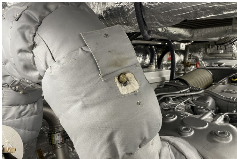
Figura 3-21 Acceso al escape de gases de L.I. GM Godínez (fuente propia)
