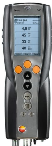
Figura 3-14 Analizador de combustión Testo 340 [61]
