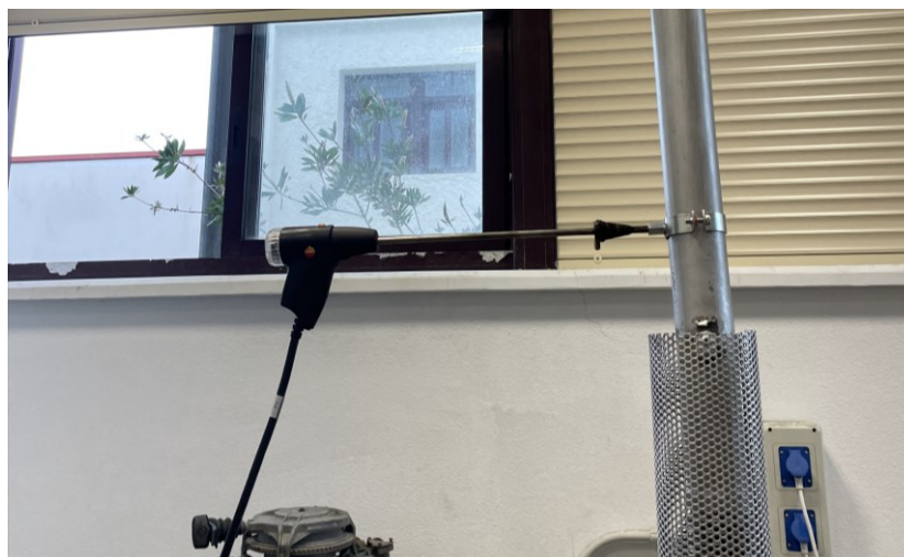
Figura 3-23 Estudio de emisión de gases en Motor Perkins (fuente propia)
