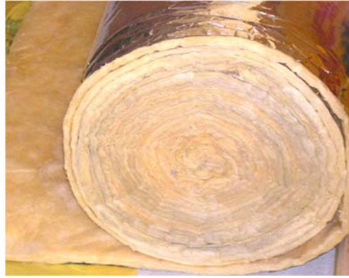
Figura 2-8 Rollo de lana mineral que se emplea en el recubrimiento de conductos de climatización
