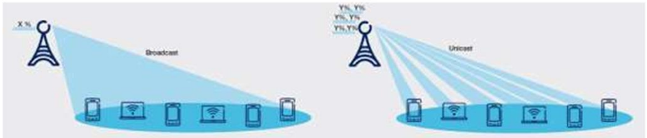
Figura 3-7 Transmisión Broadcast vs. Unicast (elaboradas a partir de [17]).
