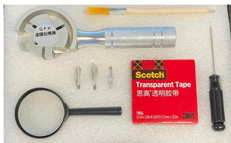
Figura 4-11 Utensilio Corte enrejado resistencia superficial
