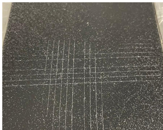
Figura 5-4 Corte por enrejado
