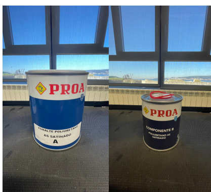
Figura 6-13 Componentes de la formulación de Poliuretano
