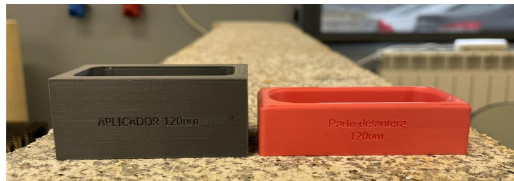
Figura 6-4 Aplicador cuadrangular inicial y modificado de impresión 3D 120 \mu\text{m}
